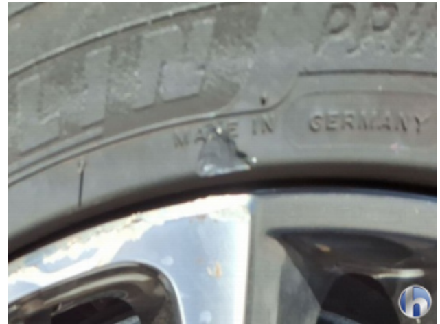
6. Reifen Vorne - Rechts Beschädigt - Erneuern
