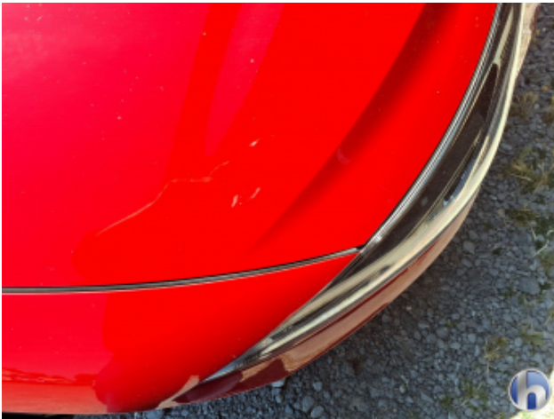
1. Motorhaube Steinschlag - Lackieren
