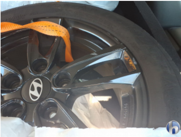
5. Zusätzlicher Radsatz Felge Außen rechts hinten Kratzer -
