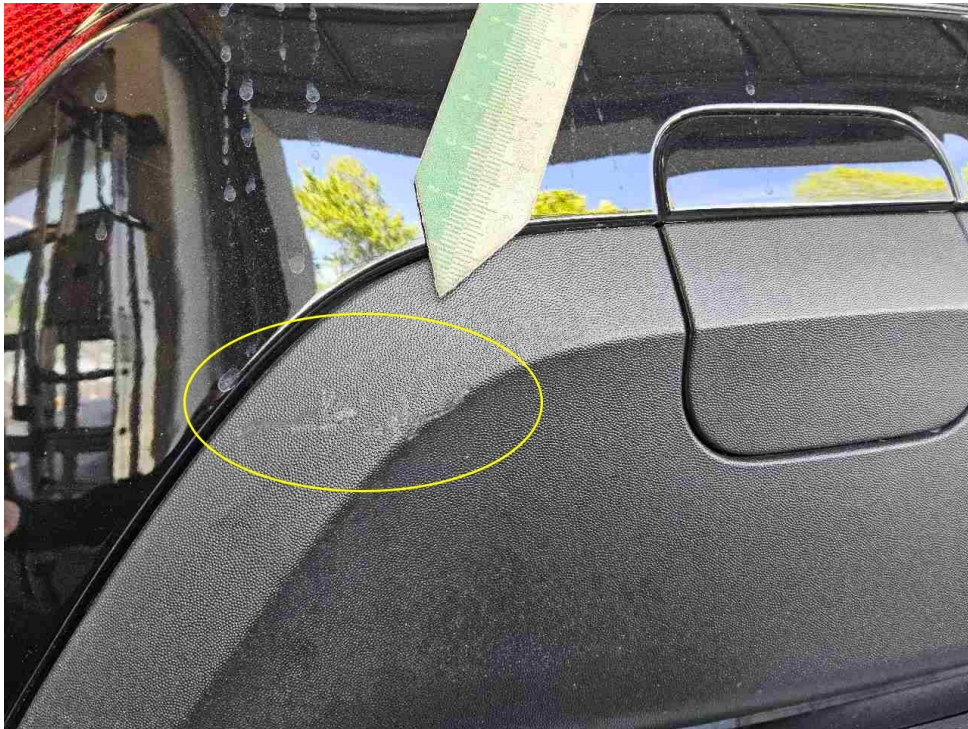
Bild 11 : Abdeckung Stoßfänger hinten Unterteil, verschrammt
