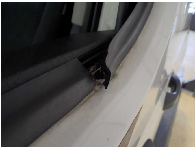
Damage 3: Door - front left side: Window guide (Dichtung) - Broken / torn - Replace
