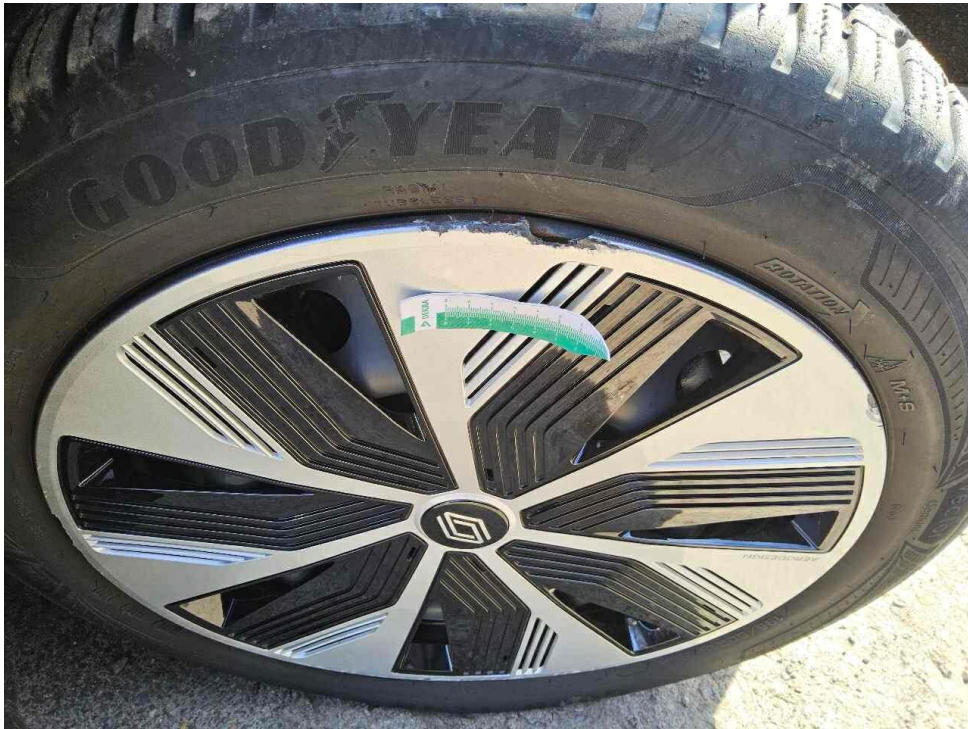
Bild 31 : Radzierblende vorne rechts, gebrochen
