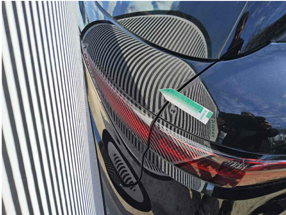
Bild 15 : Seitenteil hinten rechts, eingedellt, drücken
