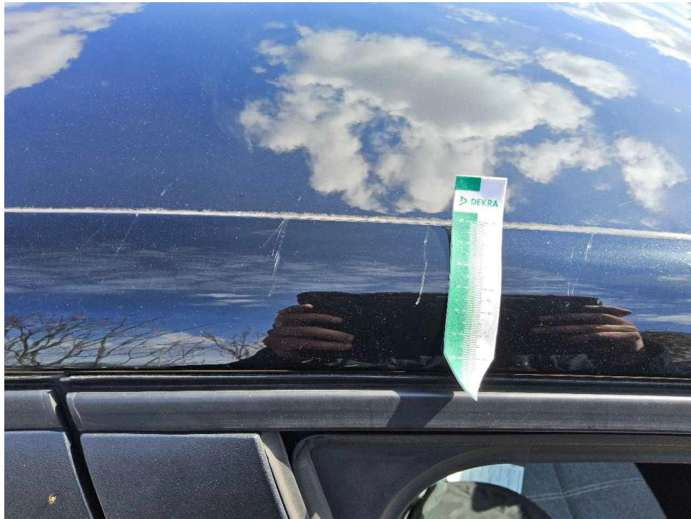
Bild 27 : Dachrahmen rechts Lackierung, zerkratzt, lackieren
