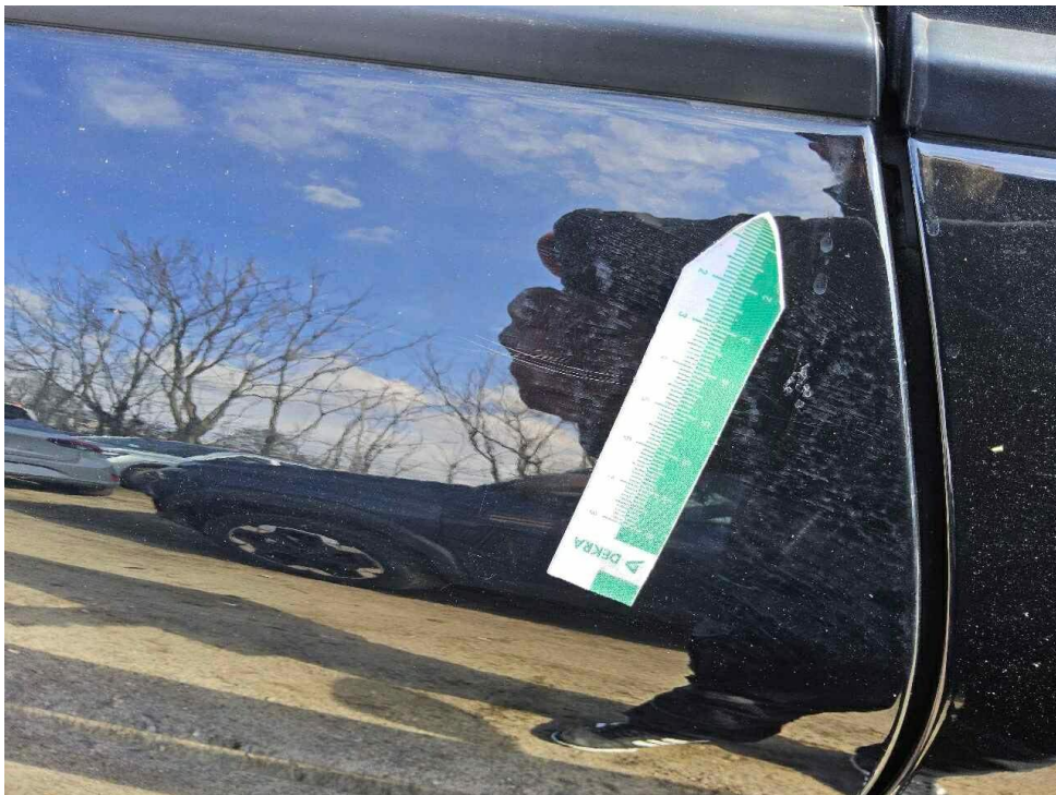
Bild 30 : Tür hinten rechts Lackierung, zerkratzt, lackieren
