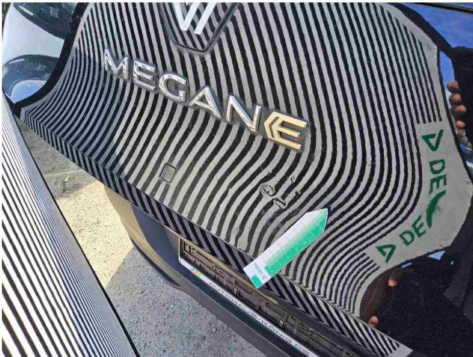
Bild 14 : Heckdeckel, deformiert, instandsetzen und lackieren mit Lackaufbau
