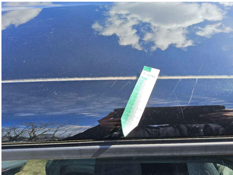
Bild 28 : Dachrahmen rechts Lackierung, zerkratzt, lackieren
