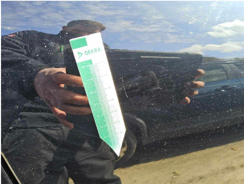
Bild 29 : Tür hinten rechts Lackierung, zerkratzt, lackieren
