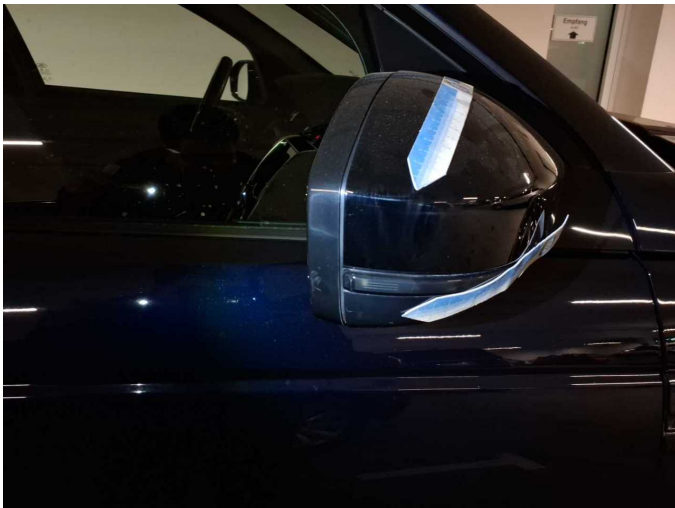
Beschädigung 4: Außenspiegel rechts: Spiegelgehäuse - Kratzer - auslegen / polieren
