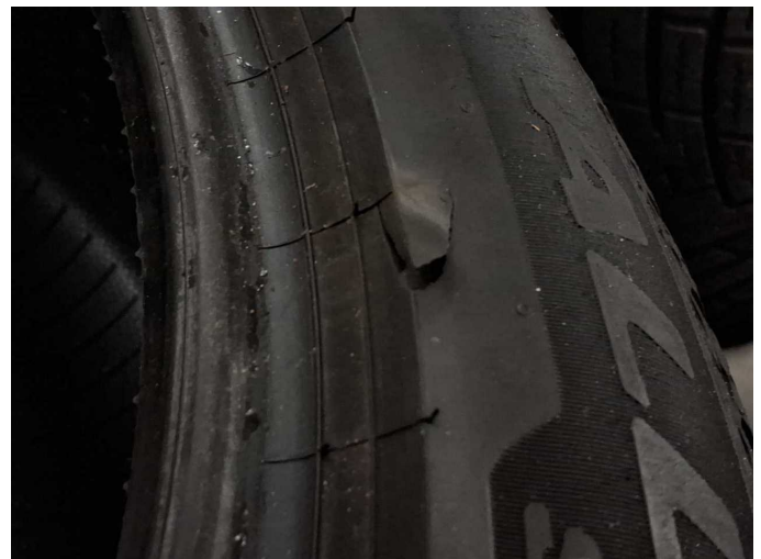
Beschädigung 5: 2.Radsatz: 1 Reifen - beschädigt - erneuern
