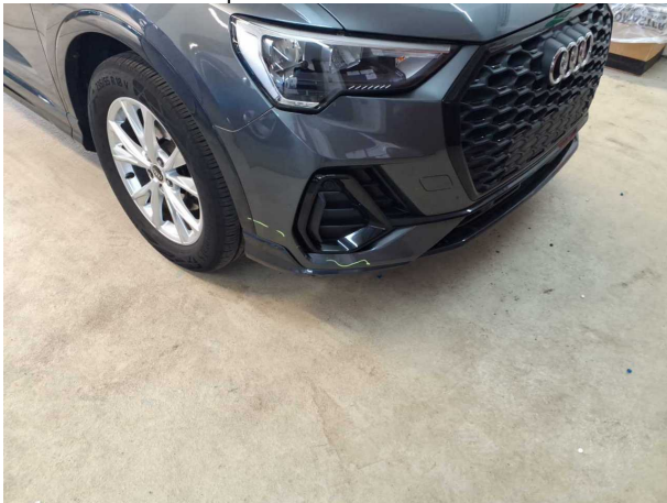
Beschädigung #5: Stossfänger vorn: Stossfänger vorn - verformt - erneuern
