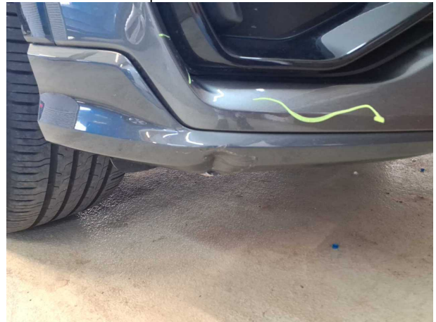
Beschädigung #5: Stossfänger vorn: Stossfänger vorn - verformt - erneuern
