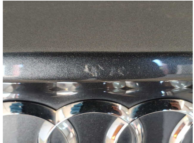
Beschädigung #3: Heckklappe/-tür: Heckklappe - verkratzt / verschürft - Smart Repair
