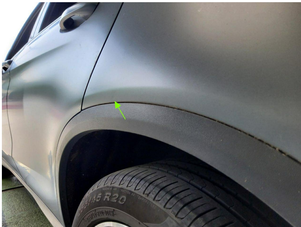
Bild 15 : Seitenteil hinten links, eingedellt, Gebrauchsspur
