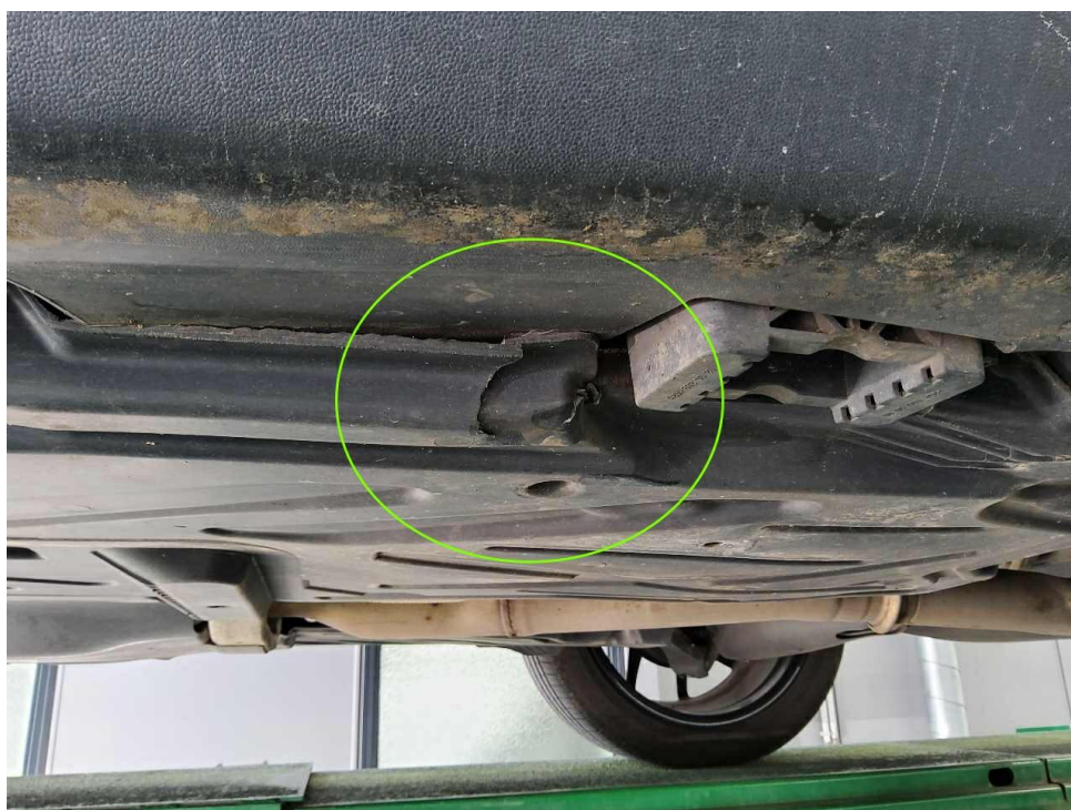
Bild 38 : Unterbodenverkl LI lang hinten gerissen
