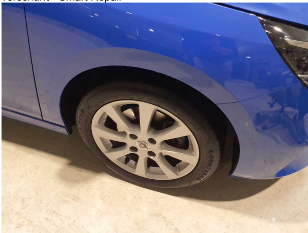
Beschädigung #5: Rad/Reifen: Reifen vorn - verschlissen - erneuern
