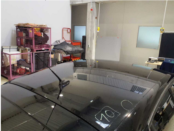
Beschädigung #7: Fahrzeugdach: Dach - Hagelschaden - sanft instandsetzen
