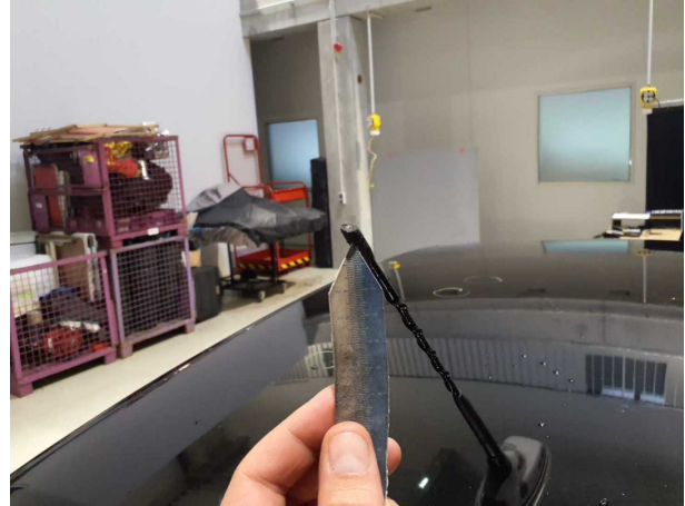
Beschädigung #1: Fahrzeugdach: Antennenstab - beschädigt - erneuern
