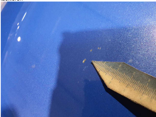
Beschädigung #9: Motorhaube: Motorhaube - verkratzt / versch... - lackieren
