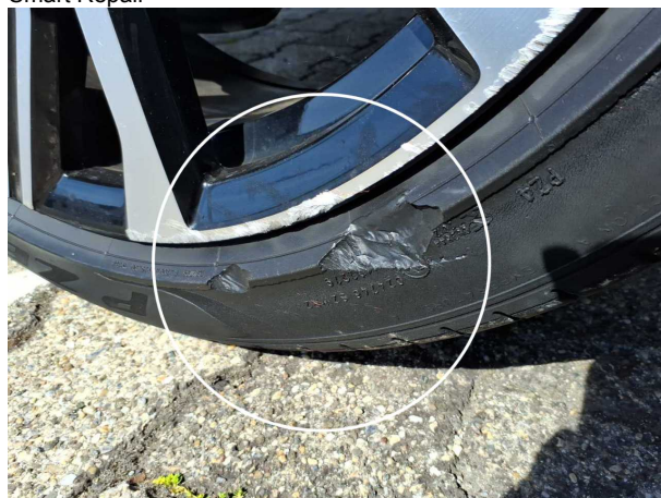
Beschädigung #7: Rad/Reifen: Reifen hinten rechts - beschädigt - erneuern
