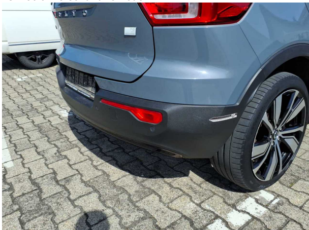
Beschädigung #10: Stossfänger hinten: Stossfänger hinten (unlackiert) - verkratzt / verschürft - erneuern
