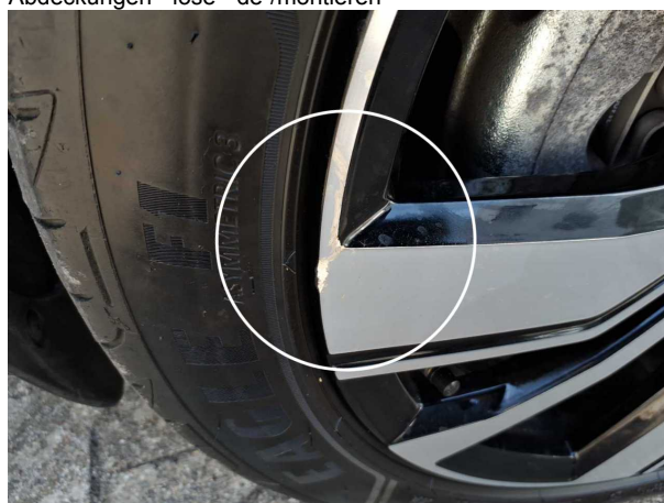
Beschädigung #2: Rad/Reifen: Leichtmetallfelge vorn links - Kratzer - Wertminderung
