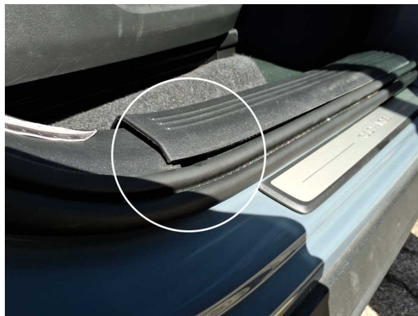
Beschädigung #1: Verkleidungen/Abdeckungen: Verkleidungen/Abdeckungen - lose - de-/montieren
