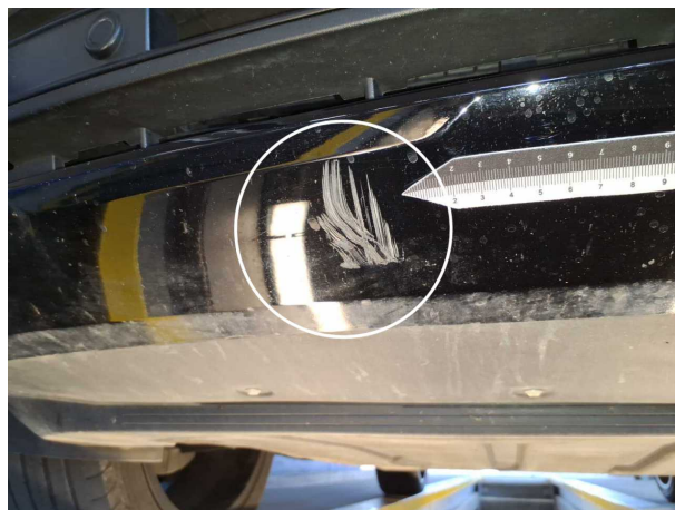
Beschädigung #6: Stossfänger vorn: Stossfänger vorn - Kratzer - Smart Repair
