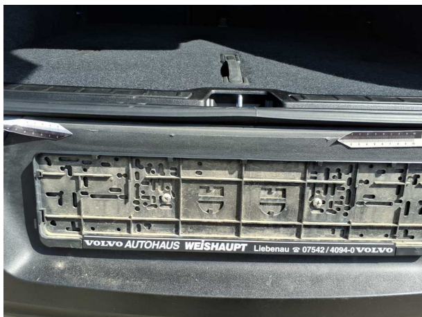
Beschädigung #10: Stossfänger hinten: Stossfänger hinten (unlacki... - verkratzt / verschürft - erneuern
