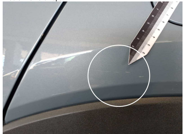
Beschädigung #5: Seitenwand links: Seitenwand - Kratzer - Smart Repair
