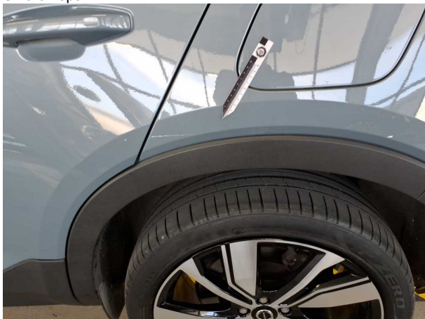
Beschädigung #5: Seitenwand links: Seitenwand - Kratzer - Smart Repair
