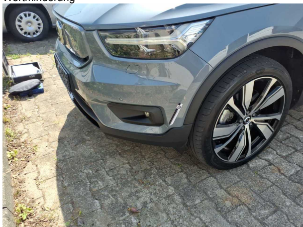
Beschädigung #3: Stossfänger vorn: Stossfänger vorn (unlackiert) - lose - de-/montieren
