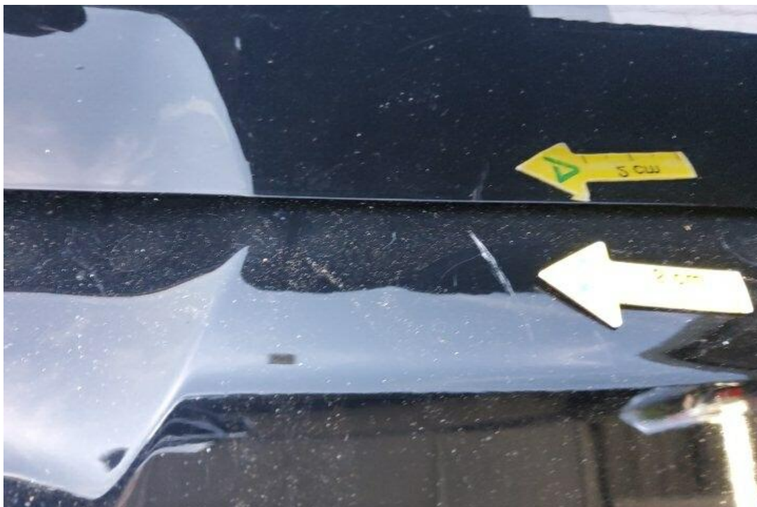
Bild 13 : Stoßfänger hinten Lackierung, zerkratzt, smart repair
