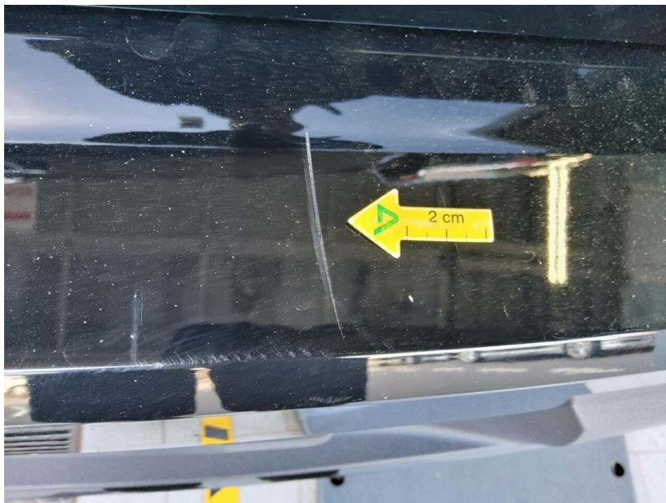
Bild 15 : Stoßfänger hinten Lackierung, zerkratzt, smart repair
