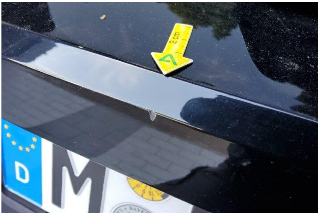
Bild 14 : Stoßfänger hinten Lackierung, zerkratzt, smart repair
