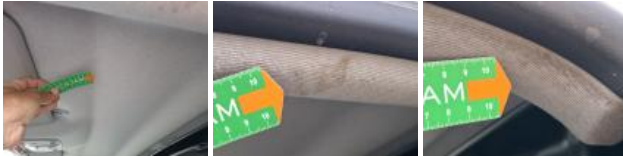
Boot door lining R, Hole, Replace
