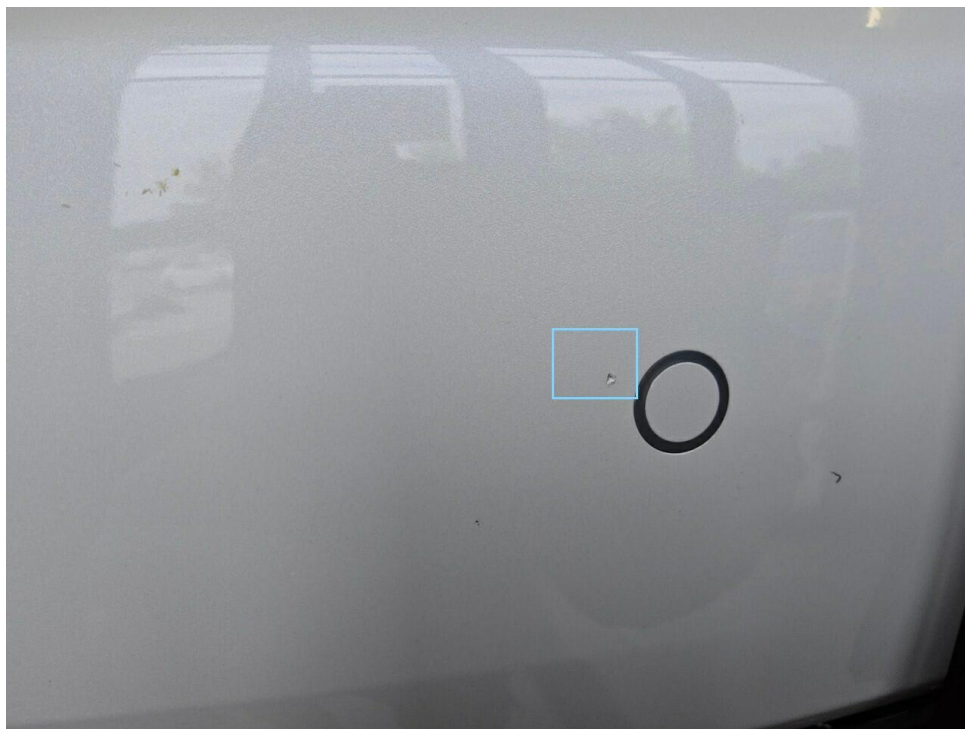
Bild 10 : Stoßfänger vorne Lackierung, Steinschlag, Gebrauchsspur
