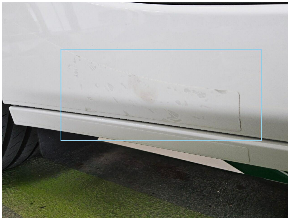
Bild 11 : Tür hinten rechts Schutzfolie defekt
