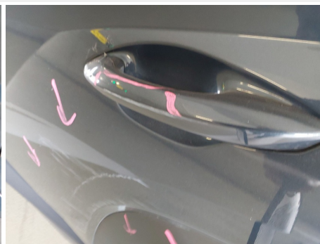
Türgriff Außen / Hinten Links / Kratzer
