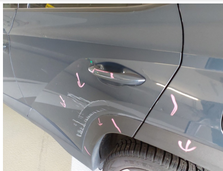
Türgriff Außen / Hinten Links / Kratzer
