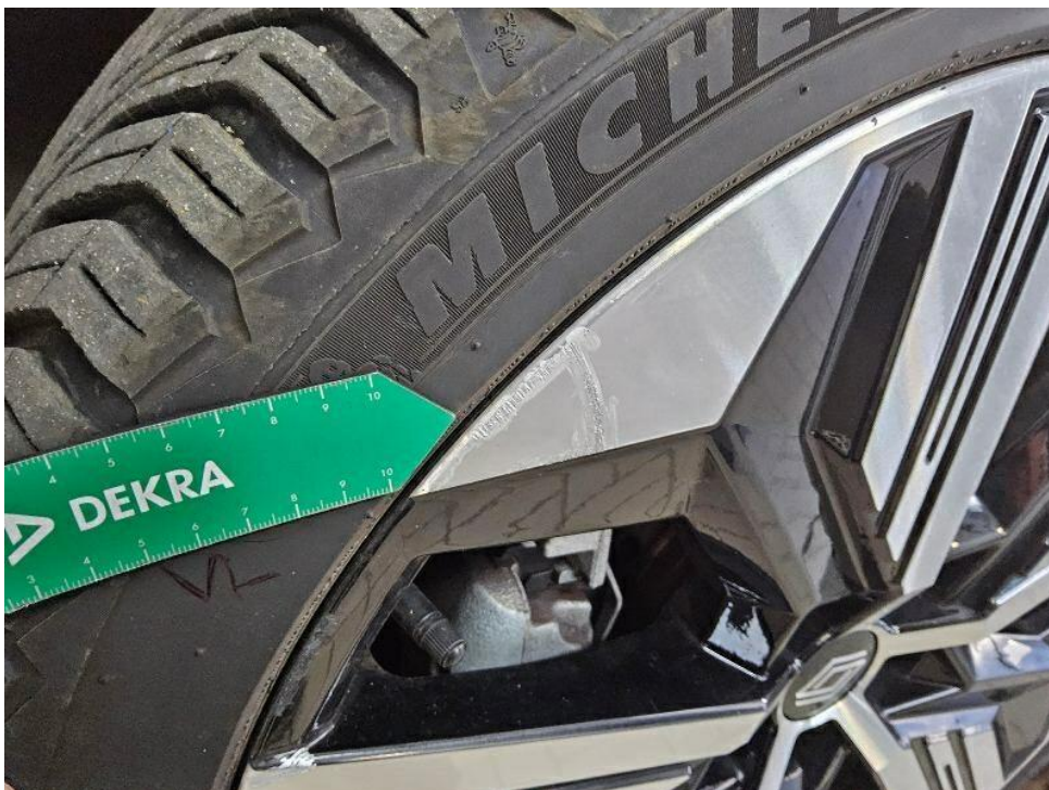
Bild 14 : Alufelge vorn links verschrammt
