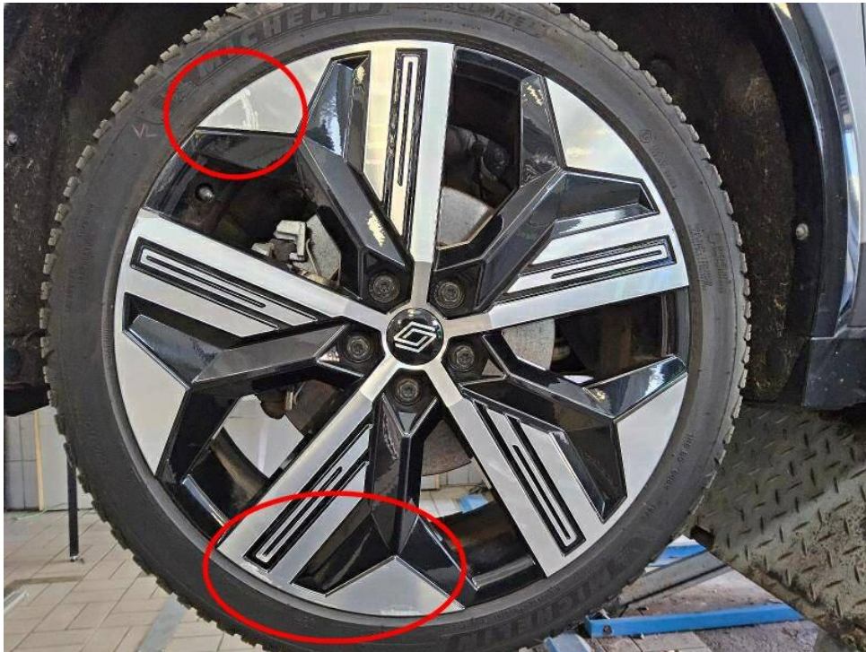
Bild 13 : Alufelge vorn links verschrammt
