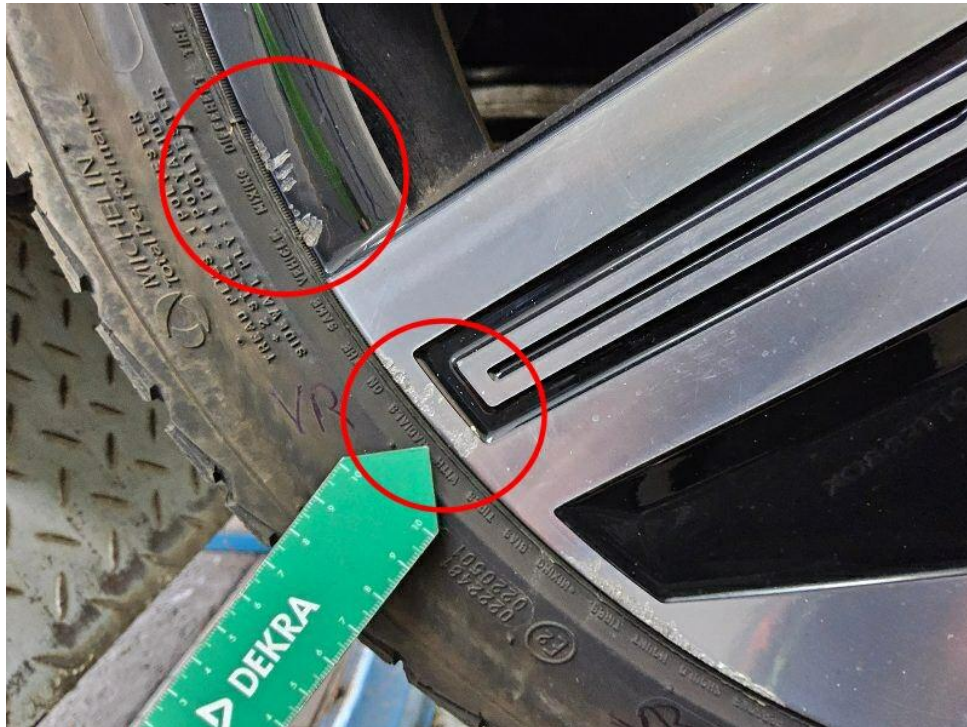
Bild 21 : Alufelge vorn rechts verschrammt
