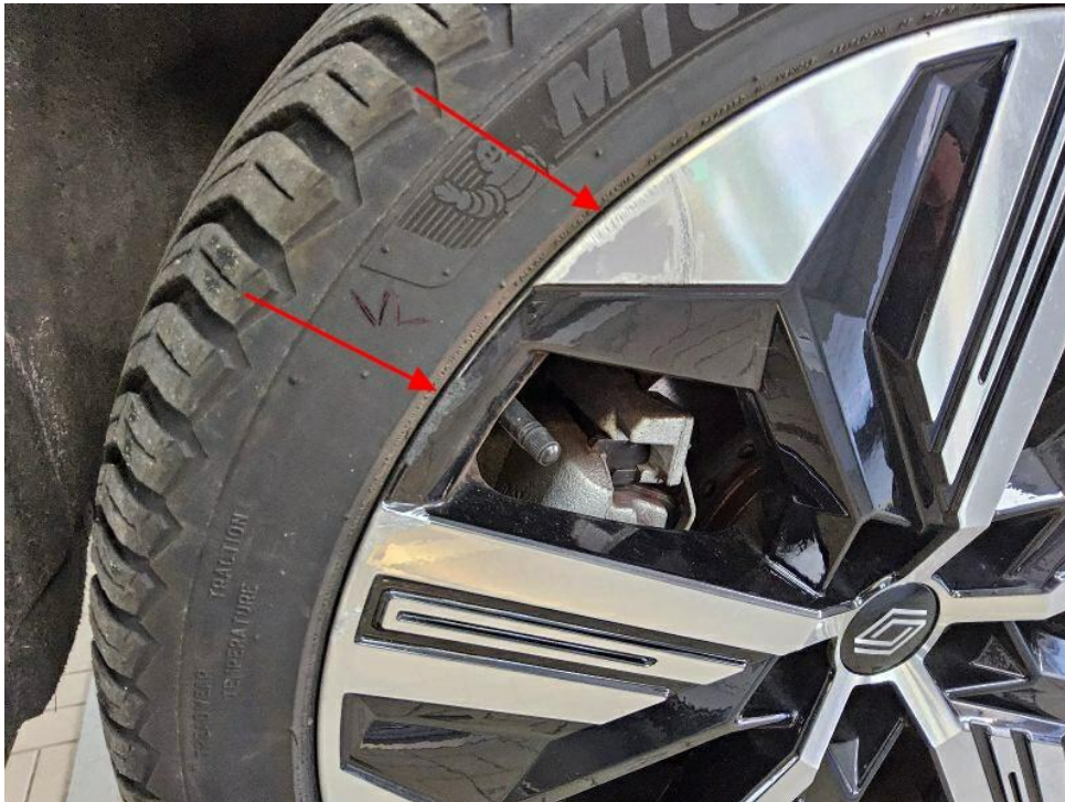
Bild 15 : Alufelge vorn links verschrammt
