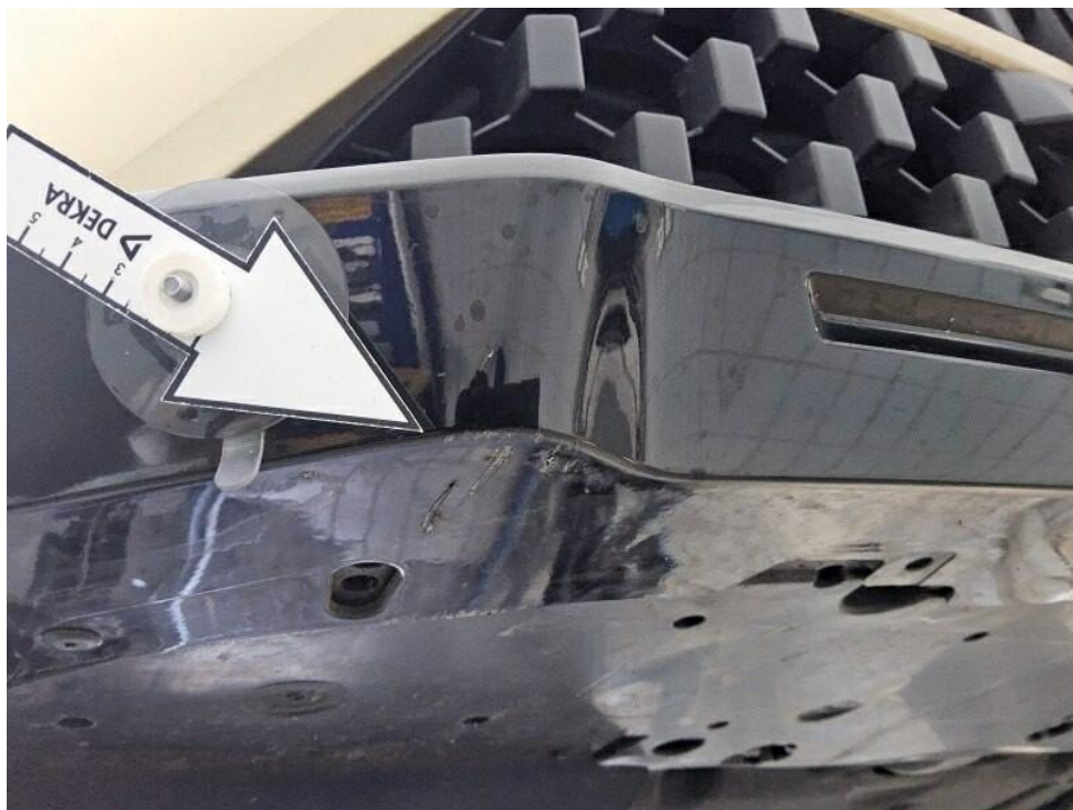
Bild 23 : Stoßfänger vorn rechts unterhalb verschrammt
