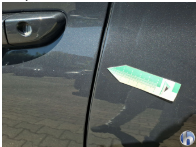
1. Tür Hinten - Links Oberflächenkratzer - Aufbereiten / Polieren
