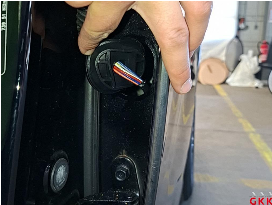
Bild 17 Kabelbaumtülle Tür hinten links lose, instand setzen
