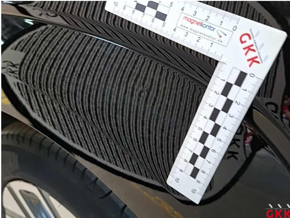
Bild 21 Kotflügel vorne links, Leiste, Radlauf -lackiert-, beschädigt, ersetzen
