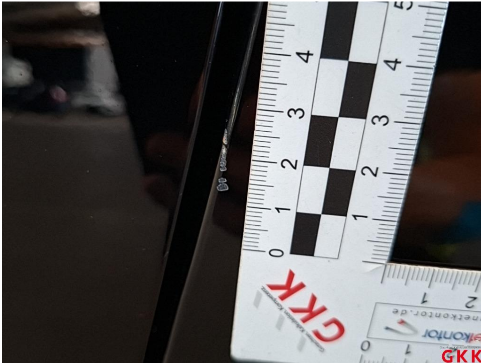
Bild 19 Seitenwand links, verkratzt, Smartrepair
