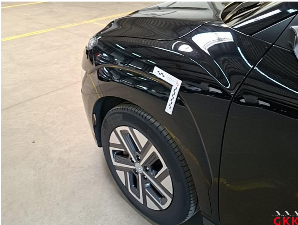
Bild 20 Kotflügel vorne links, Leiste, Radlauf -lackiert-, beschädigt, ersetzen
