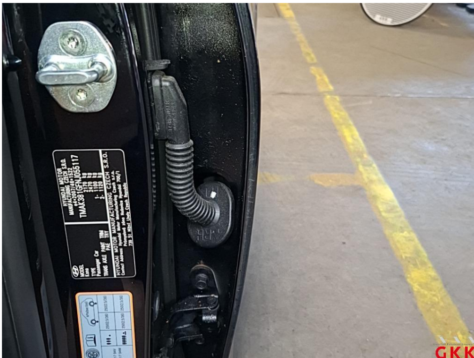
Bild 16 Kabelbaumtülle Tür hinten links lose, instand setzen
