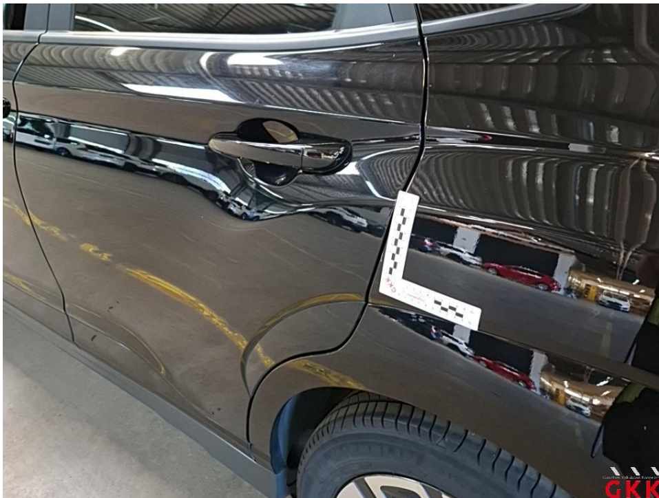
Bild 18 Seitenwand links, verkratzt, Smartrepair
