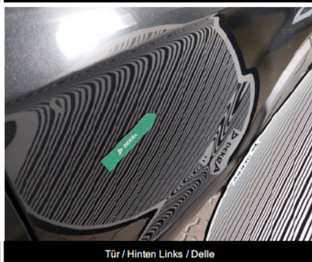
Tür / Hinten Links / Delle
