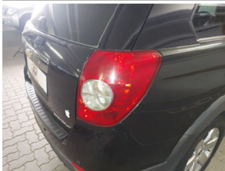
Heckleuchte / Hinten Rechts / Riss
