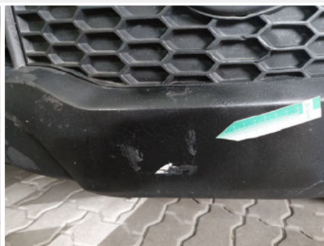
Stoßfänger unterhalb / Vorne / Riss
