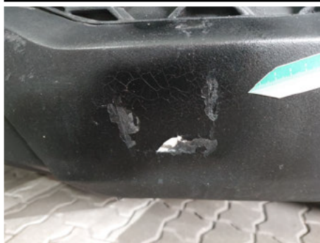
Stoßfänger unterhalb / Vorne / Riss
