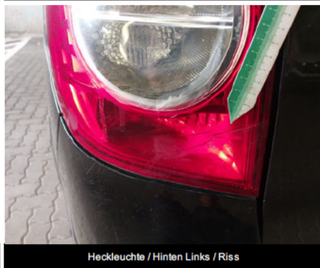
Heckleuchte / Hinten Links / Riss
