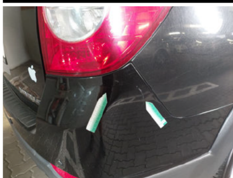
Stoßfänger / Hinten / Kratzer
