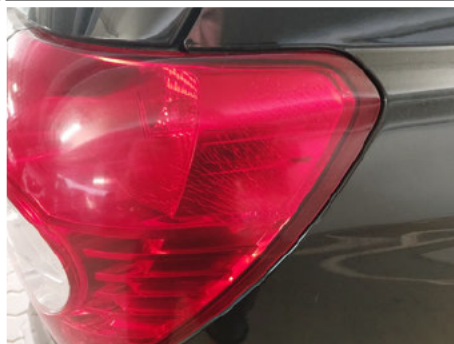
Heckleuchte / Hinten Rechts / Riss
