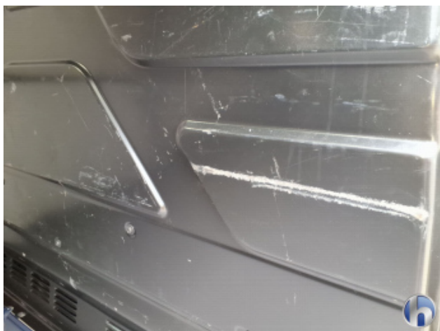
19. Trennwand Laderaum Kratzer - Nacharbeiten
