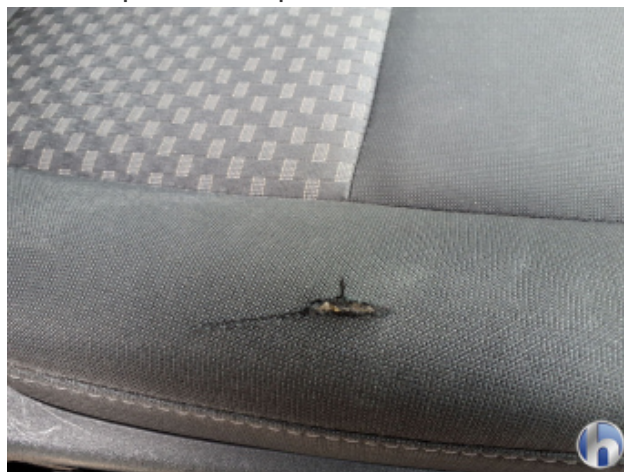
18. Sitz Innenraum rechts vorne Riss - Erneuern
