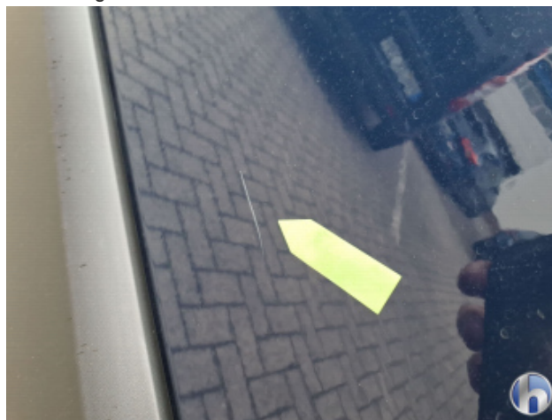
7. Seitenwand - Hinten - Links Kratzer - Smart Repair
