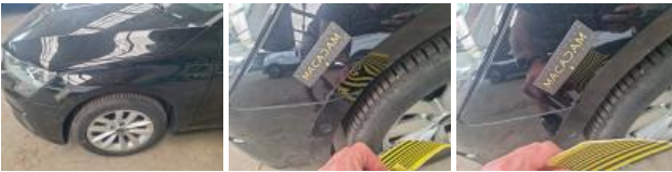
Door FL, Dent(s), Acceptable
