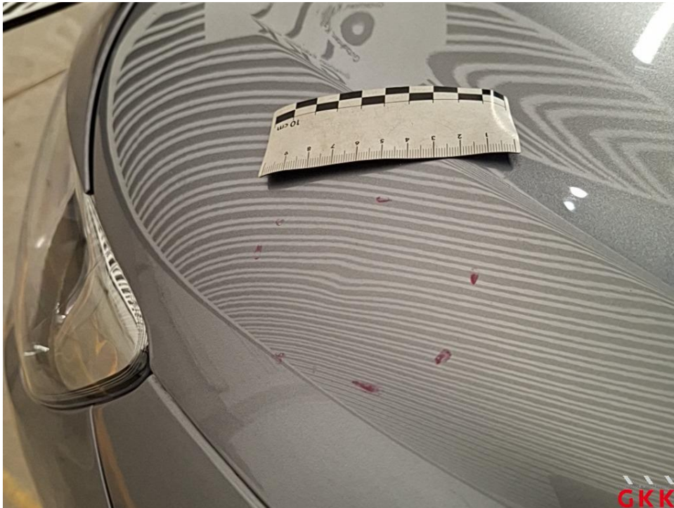
Bild 23 Motorhaube, beschädigt, instand setzen - lackieren
