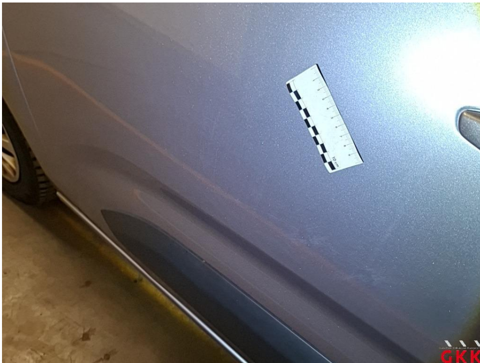
Bild 42 Fahrzeug, außen, Lackierung verwittert / matt, aufbereiten
