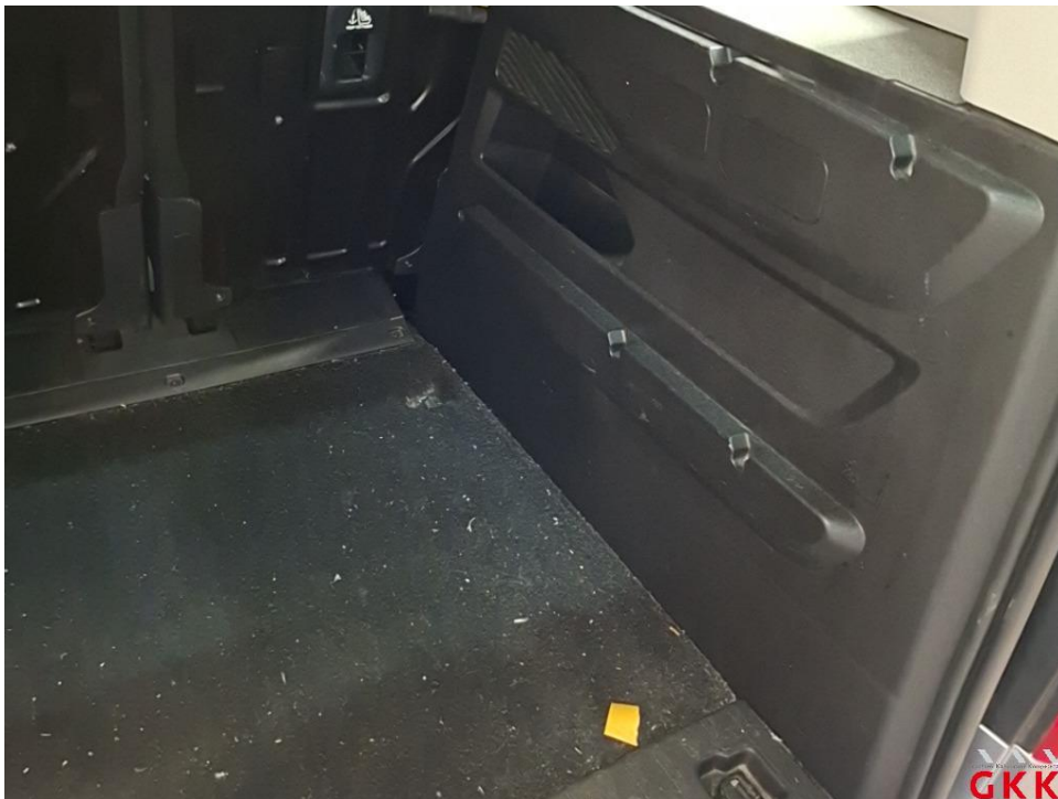
Bild 26 Fahrzeug, innen, verkratzt und verschmutzt, aufbereiten
