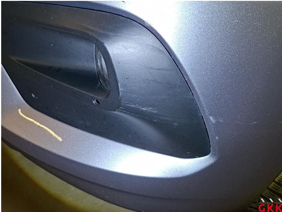
Bild 35 Nebelscheinwerfer, Blende -unlackiert-, verkratzt, ersetzen
