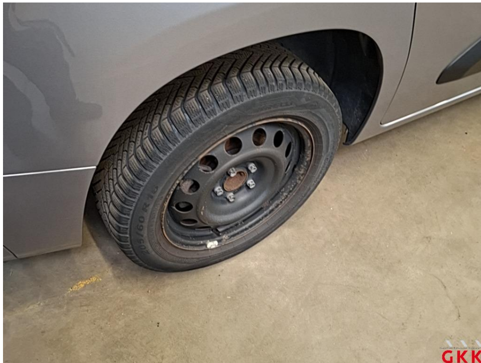
Bild 34 Radkappe(n), hinten rechts, fehlt, ersetzen
