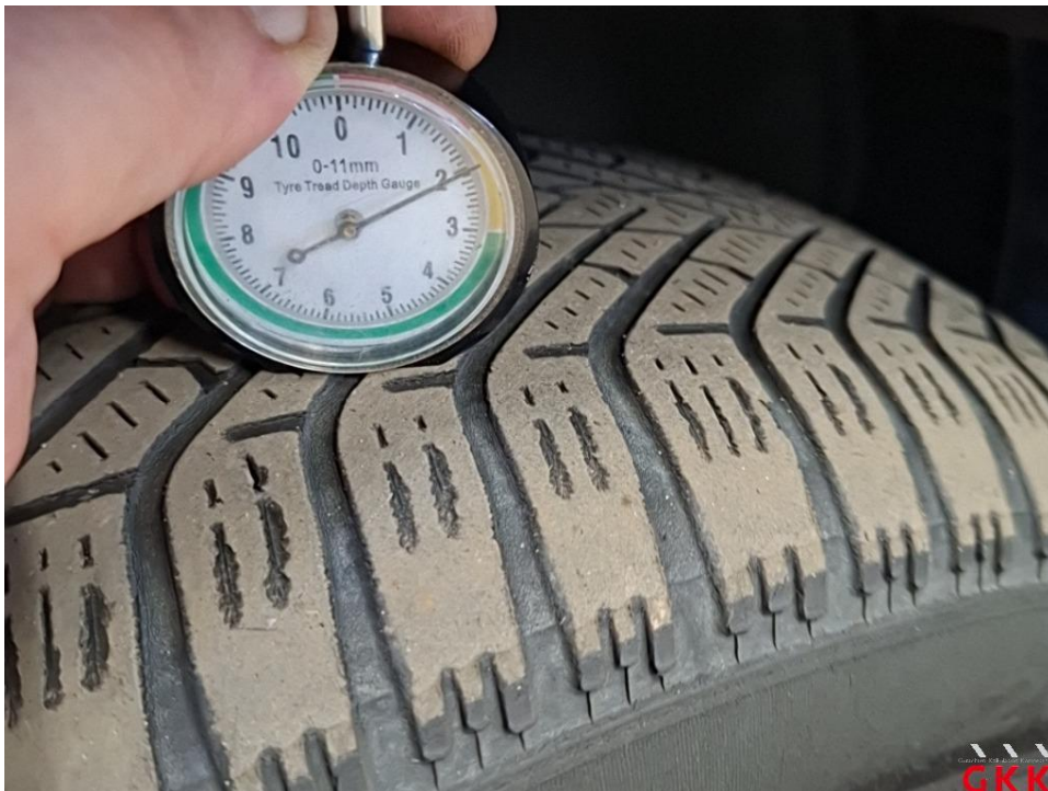
Bild 18 Reifen, vorn links und rechts, einseitig abgefahren und Untermaß, ersetzen
