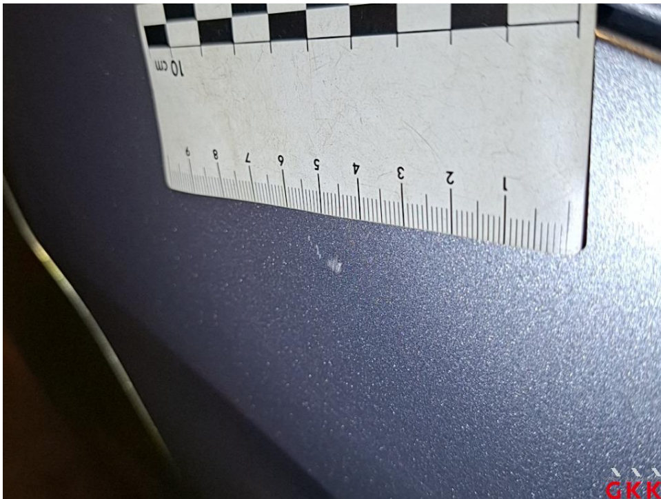
Bild 40 Kotflügel vorne links, verkratzt, lackieren
