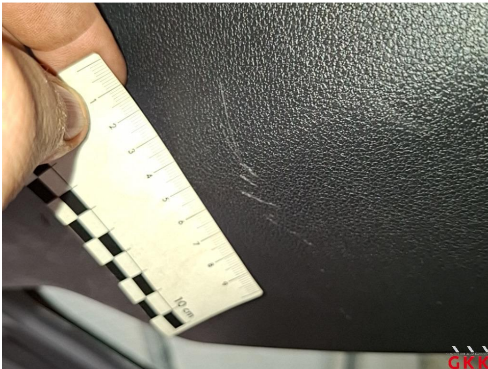
Bild 30 Heckklappe, Innenverkleidung, beschädigt, ersetzen
