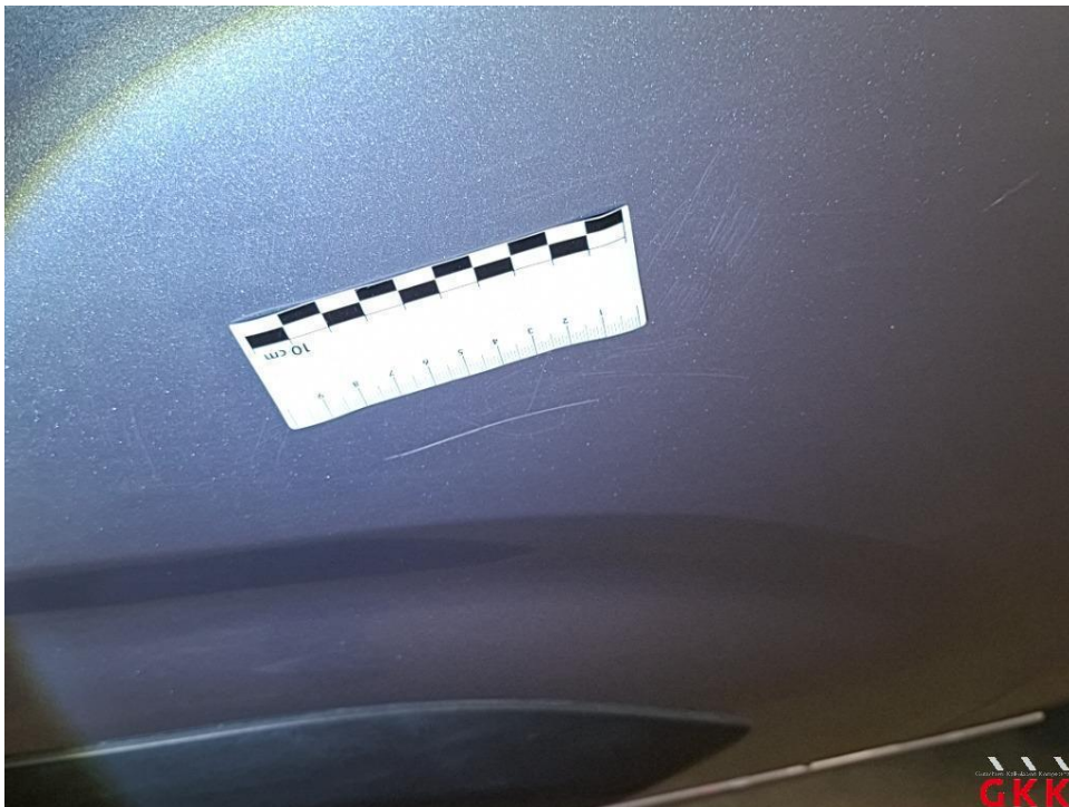
Bild 44 Fahrzeug, außen, Lackierung verwittert / matt, aufbereiten
