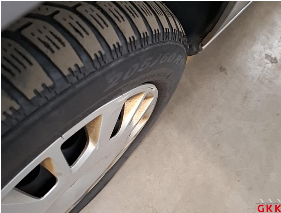
Bild 20 Reifen, vorn links und rechts, einseitig abgefahren und Untermaß, ersetzen
