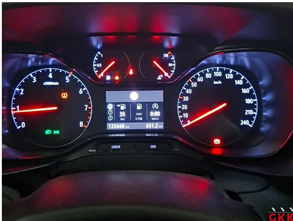
Bild 45 Kombiinstrument Kombiinstrument, Reifendruckkontrolle, aktiv, auslesen / prüfen
