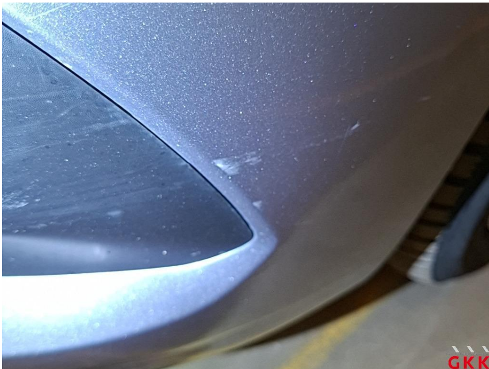
Bild 38 Stoßfänger vorne, Ecke links -lackiert-, verkratzt, lackieren
