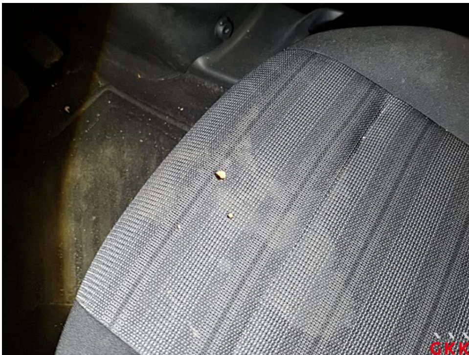
Bild 14 Sitz vorne links, Bezug Sitzkissen -Stoff-, Brandloch, ersetzen
