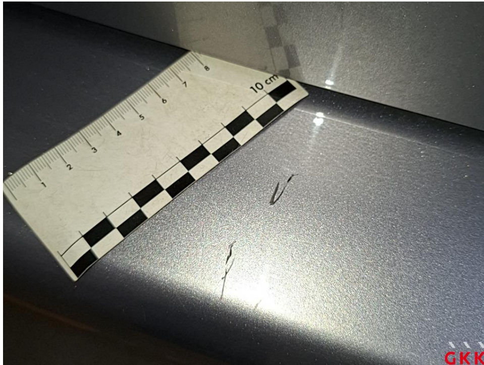
Bild 33 Stoßfänger hinten, Verkleidung -lackiert-, verkratzt, lackieren
