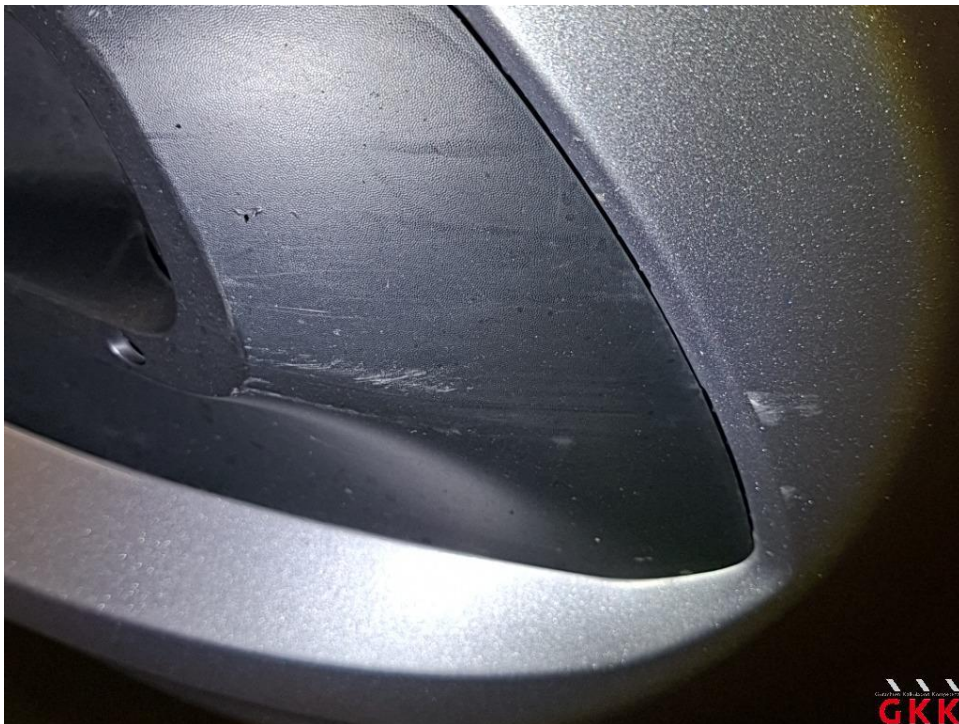
Bild 36 Nebelscheinwerfer, Blende -unlackiert-, verkratzt, ersetzen
