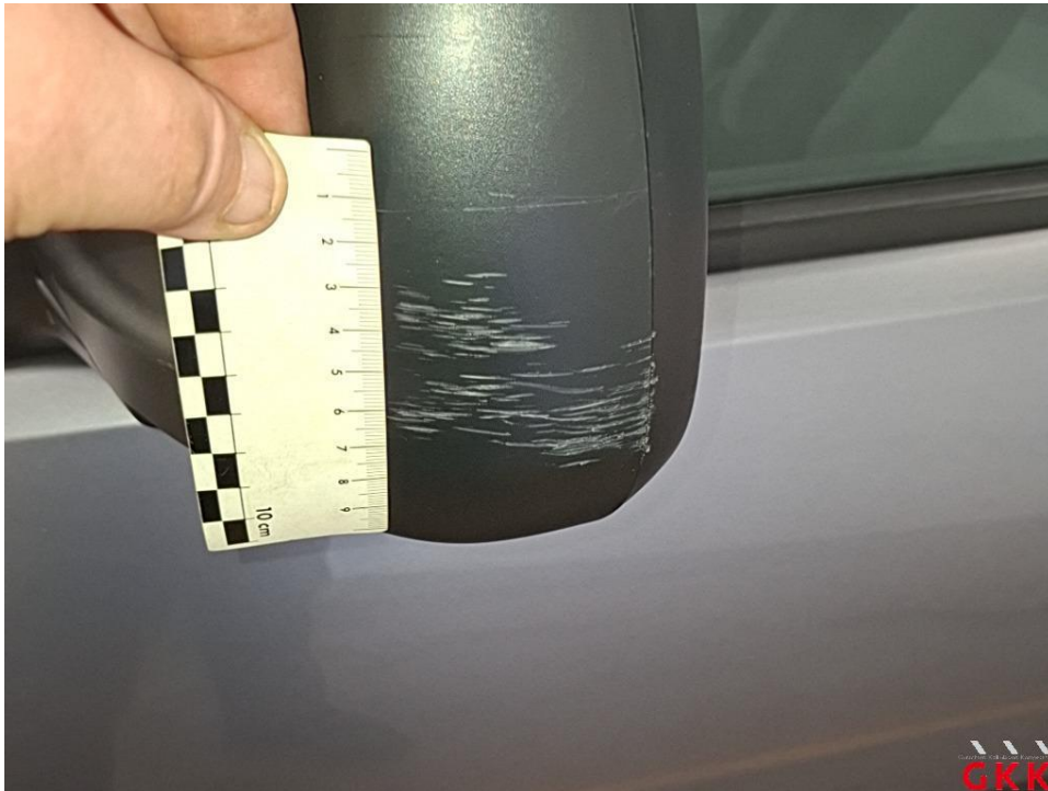
Bild 41 Spiegelgehäuse links, Kappe -unlackiert-, verkratzt, ersetzen
