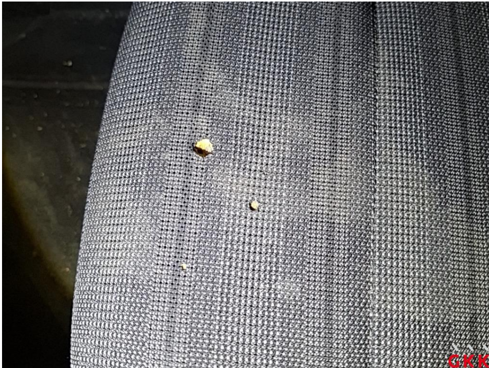
Bild 15 Sitz vorne links, Bezug Sitzkissen -Stoff-, Brandloch, ersetzen
