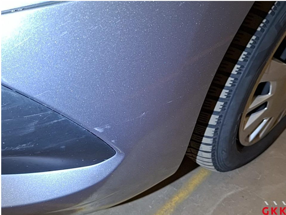
Bild 37 Stoßfänger vorne, Ecke links -lackiert-, verkratzt, lackieren
