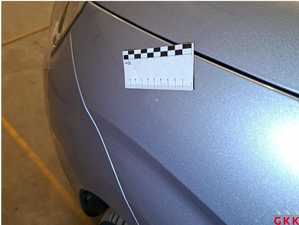
Bild 39 Kotflügel vorne links, verkratzt, lackieren
