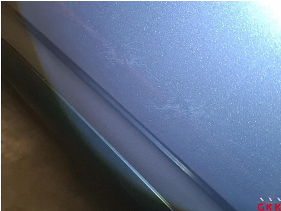
Bild 43 Fahrzeug, außen, Lackierung verwittert / matt, aufbereiten
