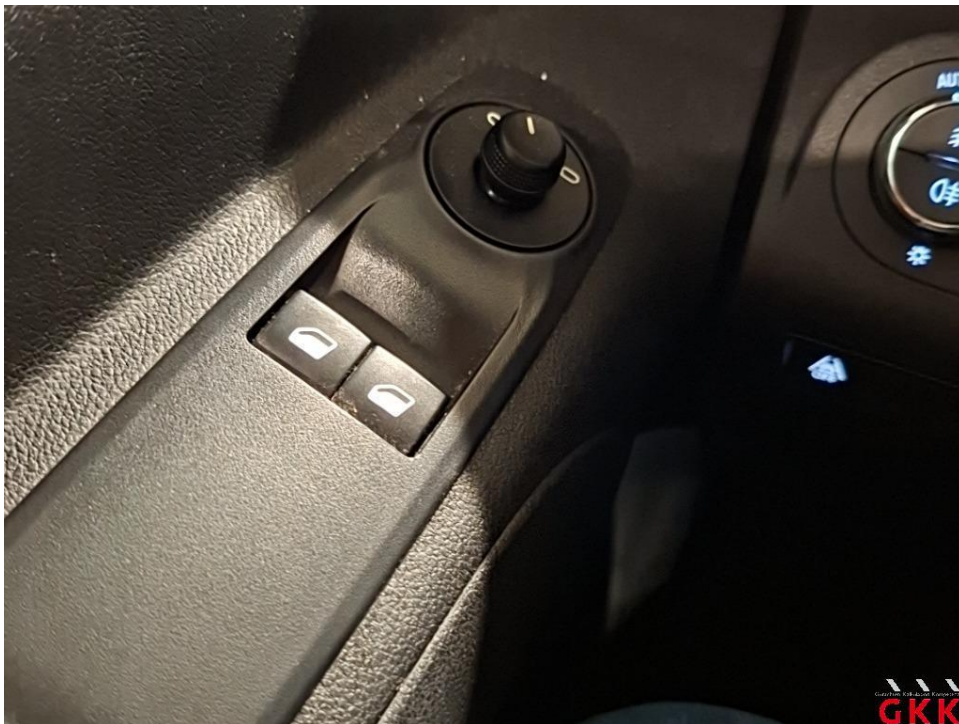
Bild 16 Tür vorne rechts, Fensterheber, funktionsuntüchtig, prüfen
