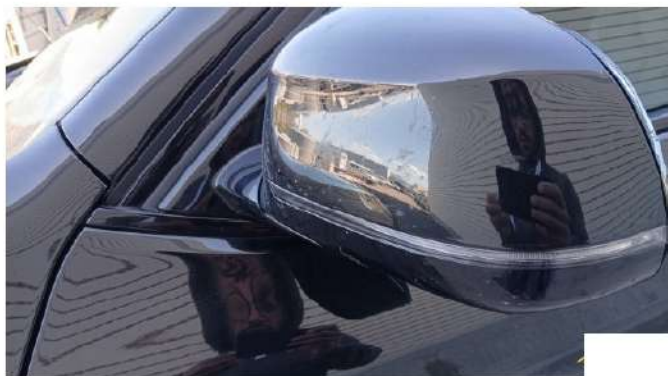
9. retrovisore esterno scatola - sinistro Graffio/Rigature
