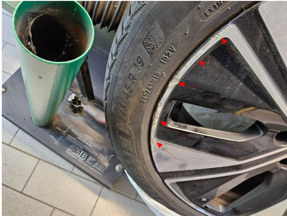
Bild 16 : Felge Winterrad verschrammt
