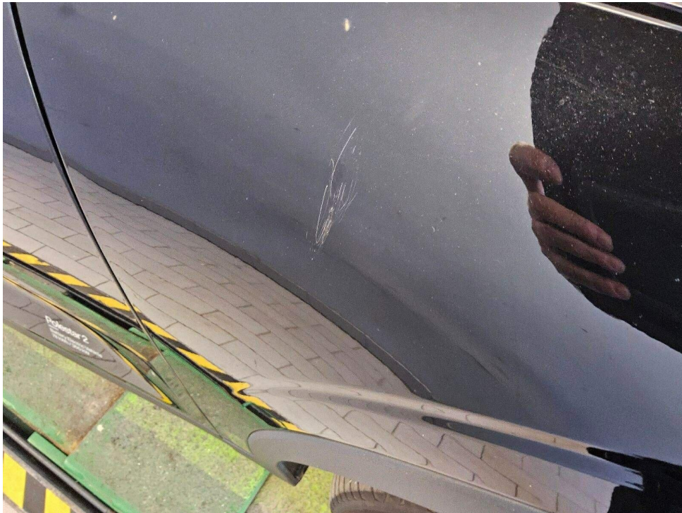
Bild 10 : Kotflügel rechts verschrammt
