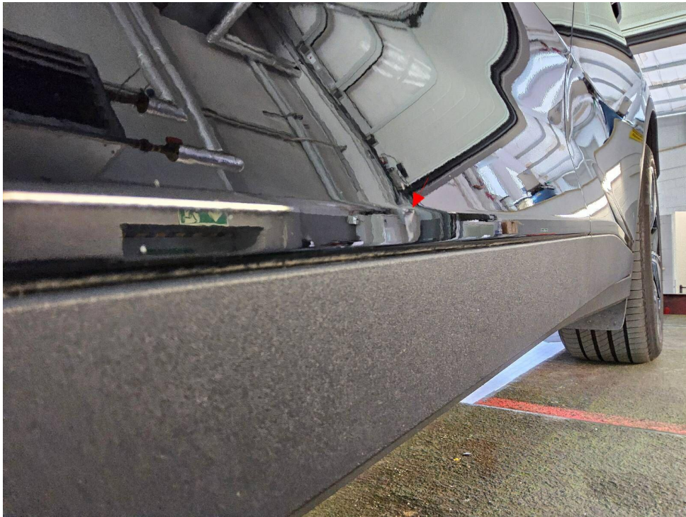
Bild 14 : Tür vorn links deformiert
