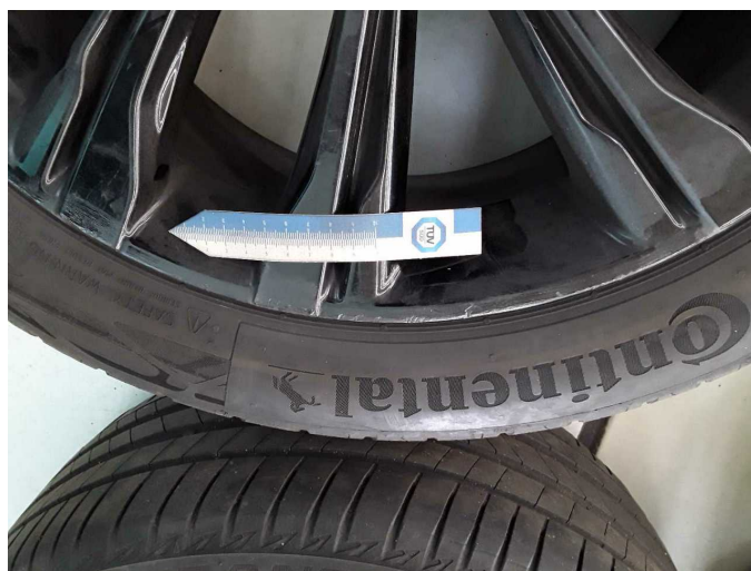
Damage 5: 2nd wheel set: 1 alloy rim (Wurde bearbeitet, verschürt) - Unprofessionally repaired - Replace
