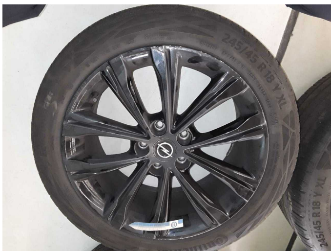
Damage 5: 2nd wheel set: 1 alloy rim (Wurde bearbeitet, verschürt) - Unprofessionally repaired - Replace
