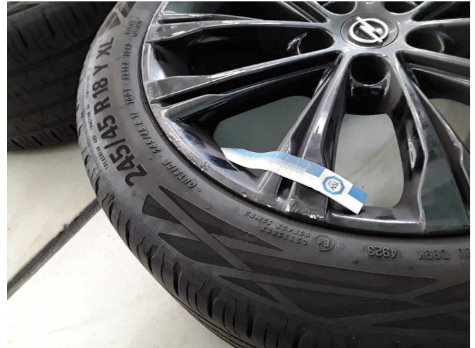
Damage 5: 2nd wheel set: 1 alloy rim (Wurde bearbeitet, verschürft) - Unprofessionally repaired - Replace
