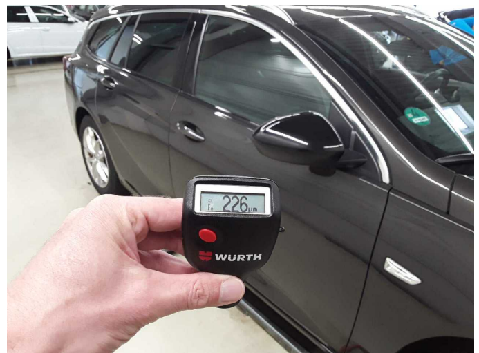
Door - front right side: 226 µm
