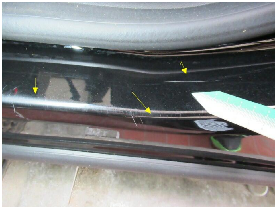
Bild 14 : Türeinstieg vorn links zerkratzt
