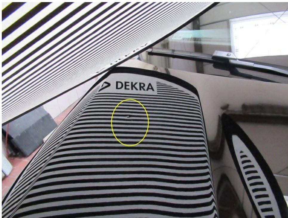
Bild 13 : Motorhaube rechts eingedellt
