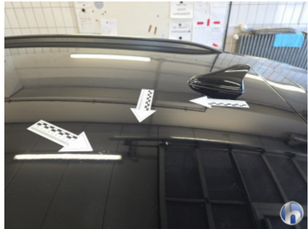
1. Dach Verätzung - Aufbereiten / Polieren
