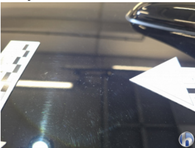
1. Dach Verätzung - Aufbereiten / Polieren
