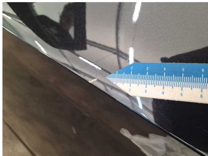
Damage 3: Door - front left side: Door - Scratch(es) - Paint
