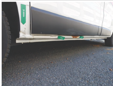
Schweller / Rechts / Rost
