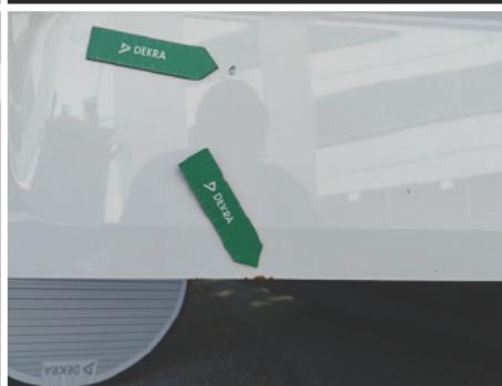
Heckklappe / Kofferraumtür / Hinten Rechts / Rost
