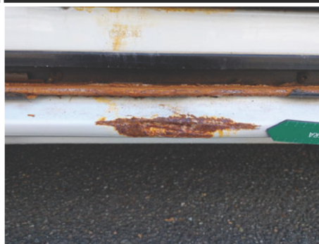
Schweller / Rechts / Rost
