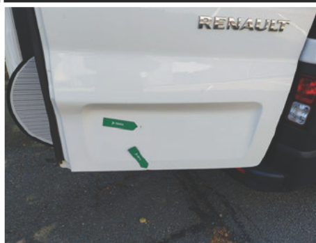
Heckklappe / Kofferraumtür / Hinten Rechts / Rost
