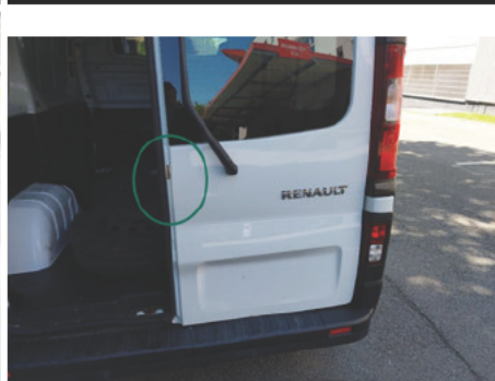
Heckklappe / Kofferraumtür / Hinten Rechts / Rost
