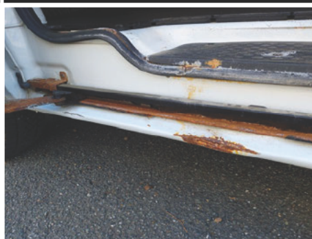
Führung Schiebetür / Rechts / Rost
