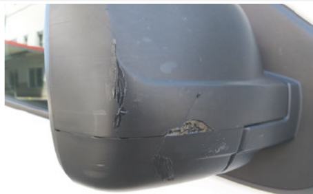
Außenspiegelkappe / Rechts / Riss
