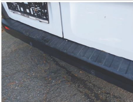
Stoßfänger / Hinten / Abgewetzt
