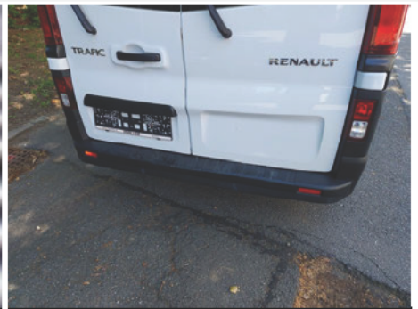
Stoßfänger / Hinten / Abgewetzt
