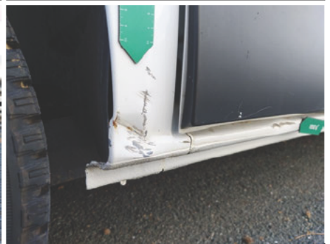
Schweller / Rechts / Rost
