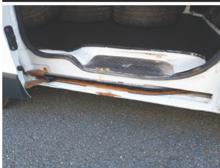
Führung Schiebetür / Rechts / Rost
