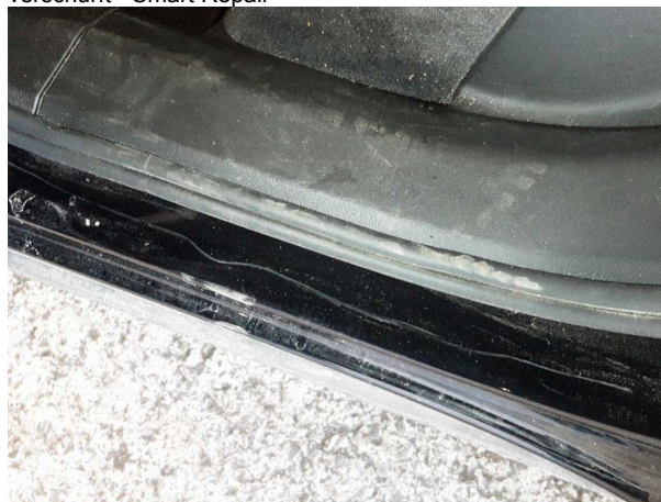
Beschädigung #7: Seitenwand links: Einstieg - verkratzt / verschürft - lackieren
