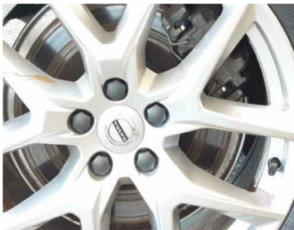
Beschädigung #8: Bremsanlage: Bremsscheiben und Beläge hinten - Korrosion - erneuern
