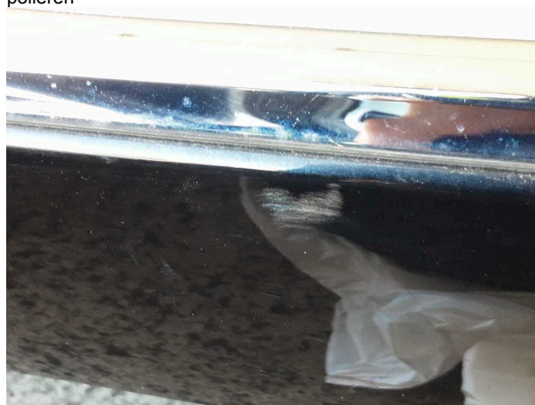
Beschädigung #3: Stossfänger hinten: Stossfänger hinten - verkratzt / verschürft - auslegen / polieren
