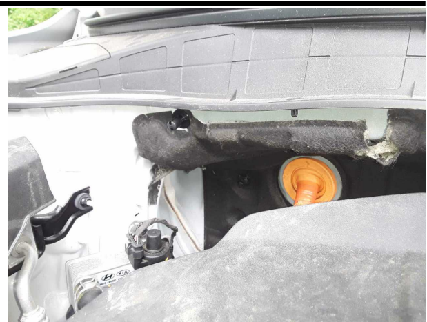
Beschädigung #6: Motorhaube: Dämmmatte (inklusive Dämmung Stirnwand erneuern) - Marderschaden - erneuern
