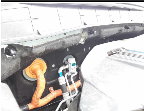
Beschädigung #6: Motorhaube: Dämmmatte (inklusive Dämmung Stirnwand erneuern) - Marderschaden - erneuern
