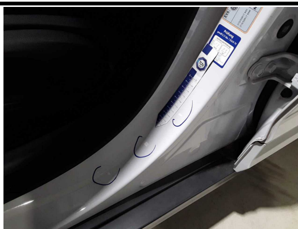
Beschädigung #4: Schweller links: Einstieg - Delle / Lackschaden - sanft instandsetzen
