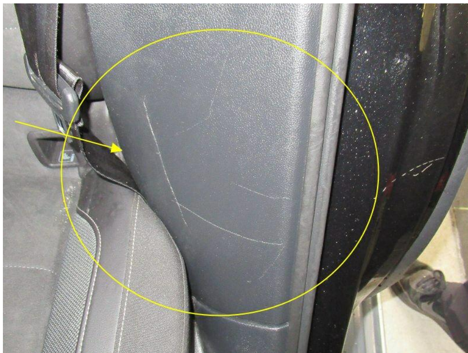
Bild 14 : Einstiegsverkleidung hinten links zerkratzt
