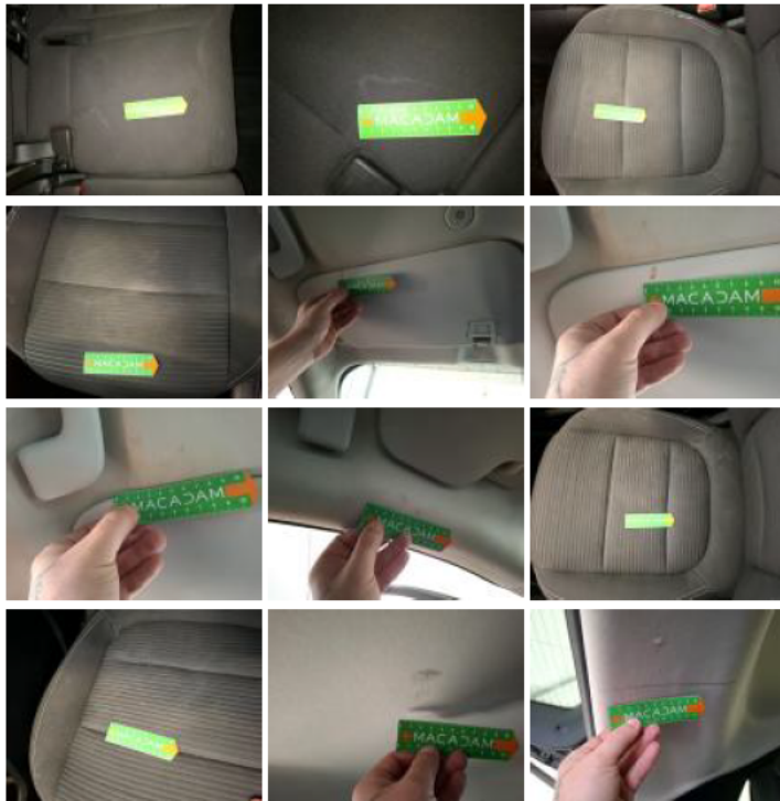
Ciel de toit, Déchirure, E - Remplacer
