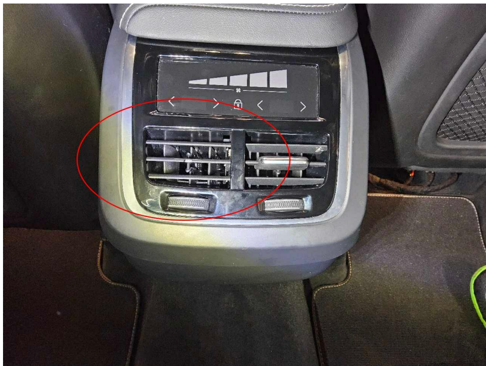
Bild 15 : Luftausströmer Mittelkonsole hinten gebrochen
