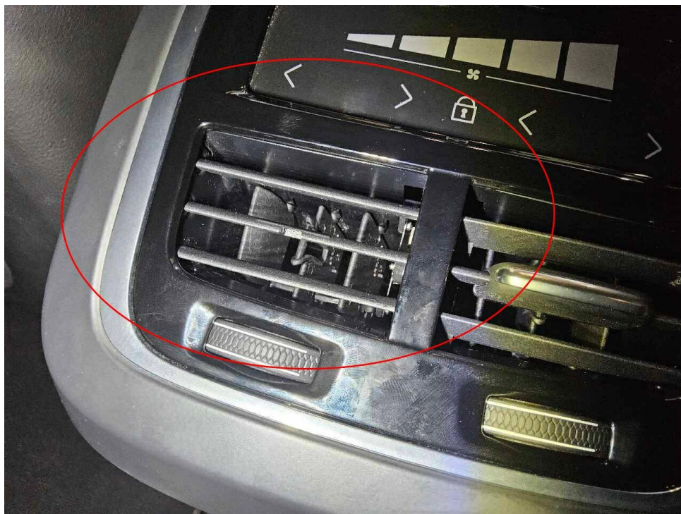
Bild 14 : Luftausströmer Mittelkonsole hinten gebrochen
