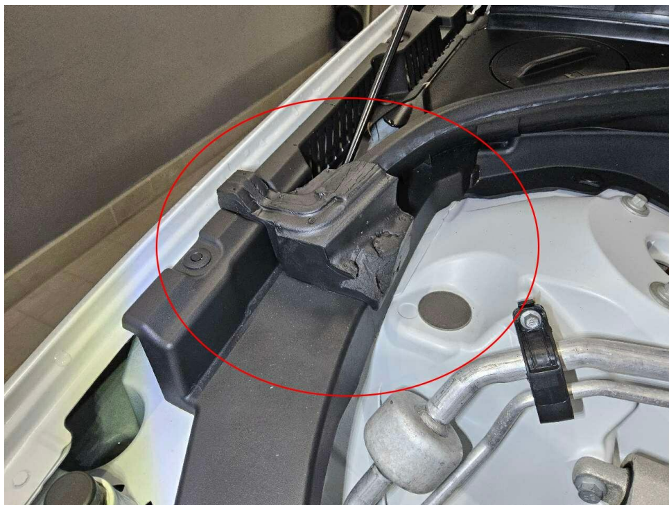
Bild 18 : Motorraum Dämmung Tierverbiss
