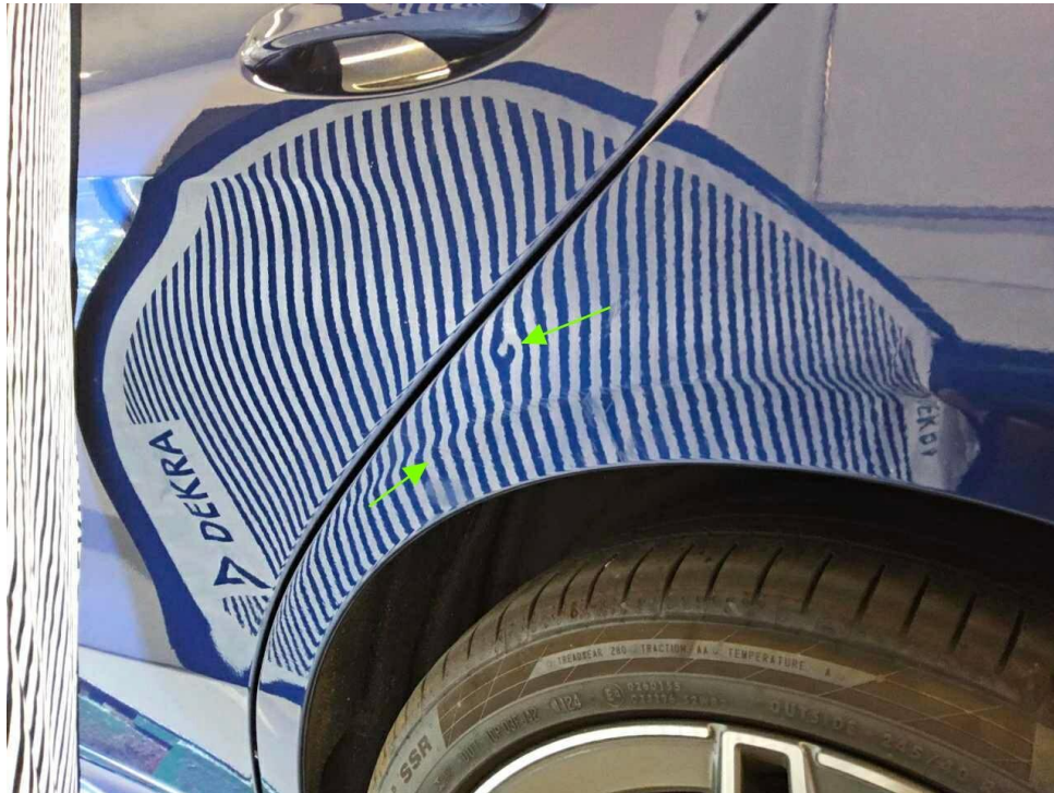
Bild 19 : Seitenteil hinten links Kniestück, eingedellt, instandsetzen und lackieren mit Lackaufbau
