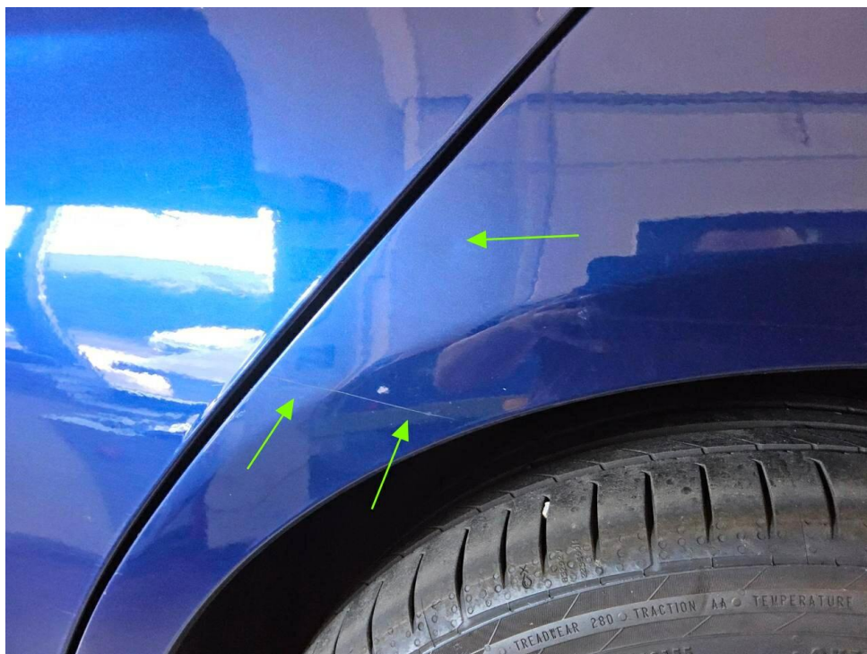
Bild 20 : Seitenteil hinten links Kniestück, eingedellt, instandsetzen und lackieren mit Lackaufbau
