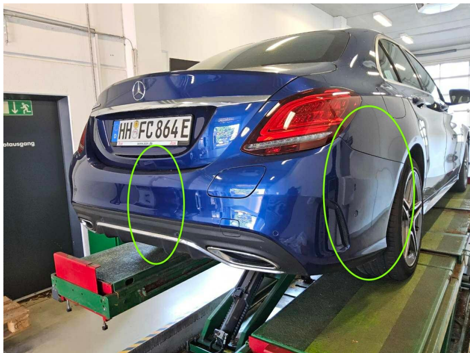
Bild 16 : Stoßfänger hinten, deformiert, instandsetzen und lackieren mit Lackaufbau
