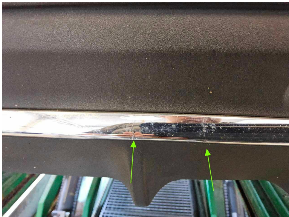
Bild 26 : Stoßfänger hinten, Zierleiste deformiert
