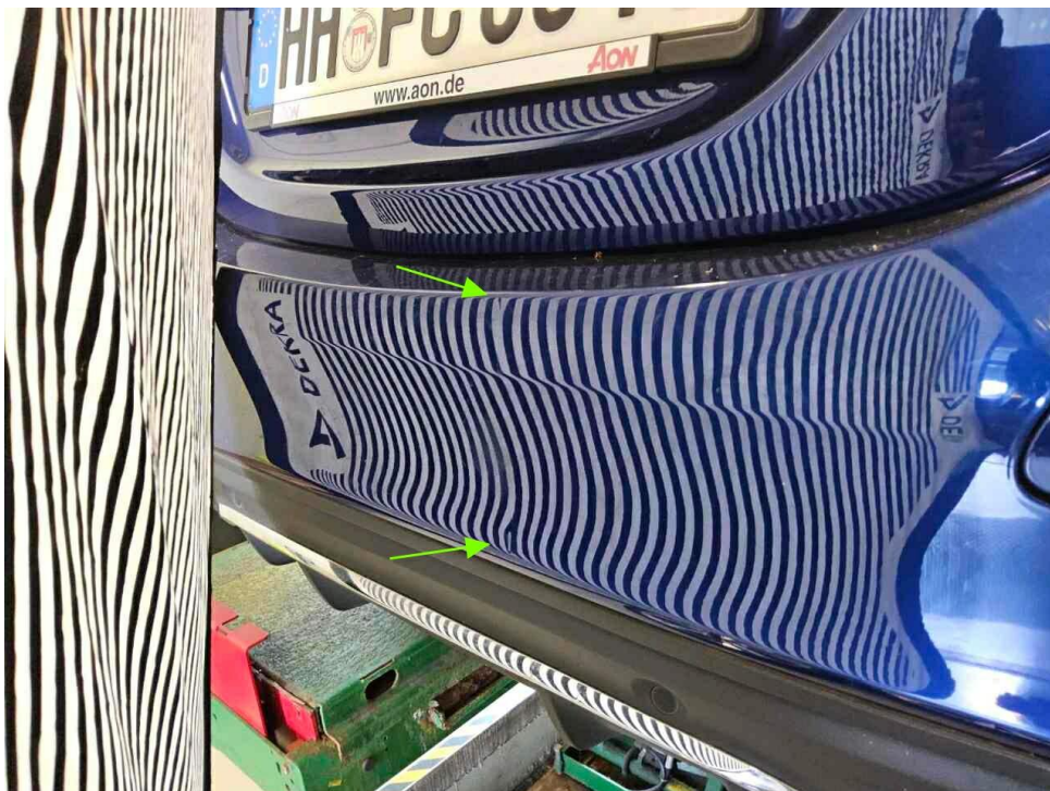
Bild 18 : Stoßfänger hinten, deformiert, instandsetzen und lackieren mit Lackaufbau
