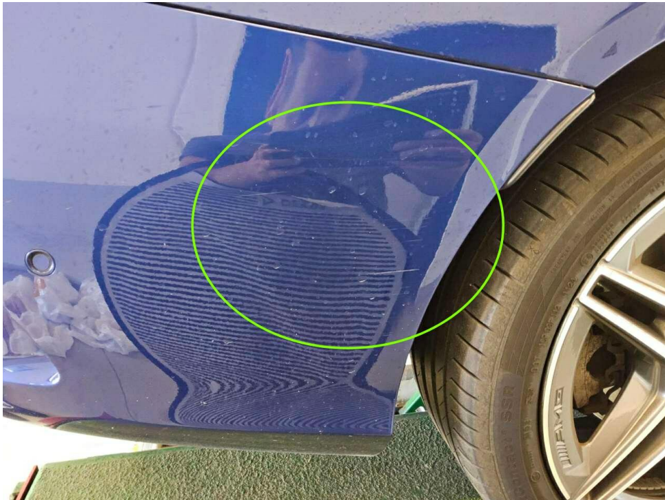
Bild 17 : Stoßfänger hinten, deformiert, instandsetzen und lackieren mit Lackaufbau
