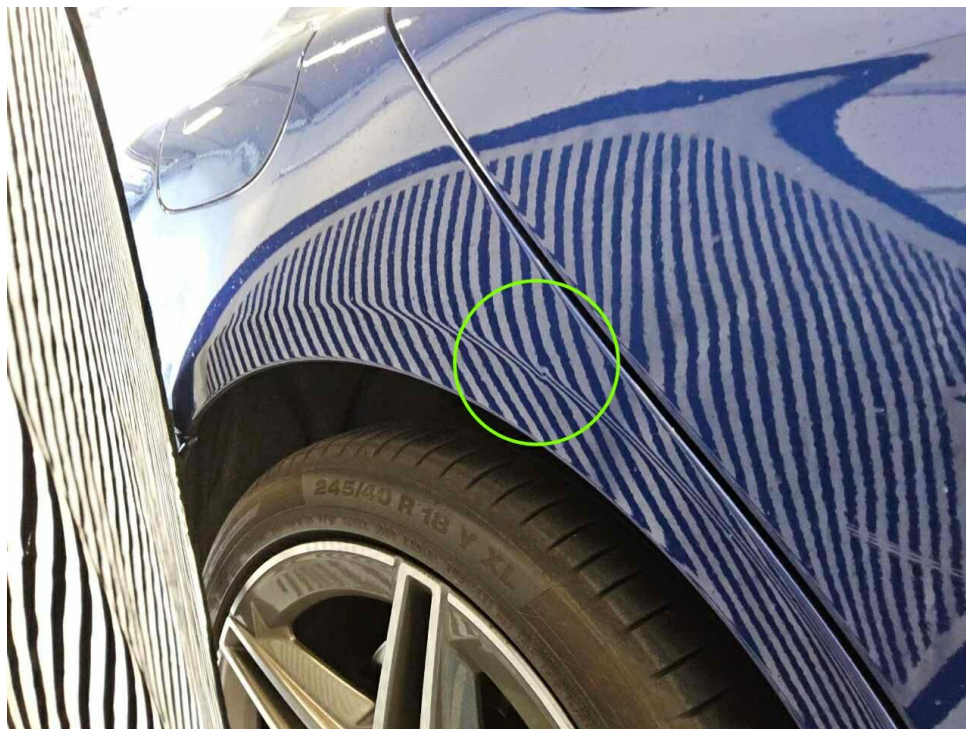
Bild 15 : Seitenteil hinten rechts, eingedellt, drücken
