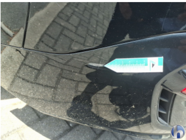
11. Stoßfänger Hinten Kratzer - Lackieren
