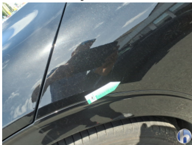
5. Kotflügel Vorne - Links Kratzer - Smart Repair
