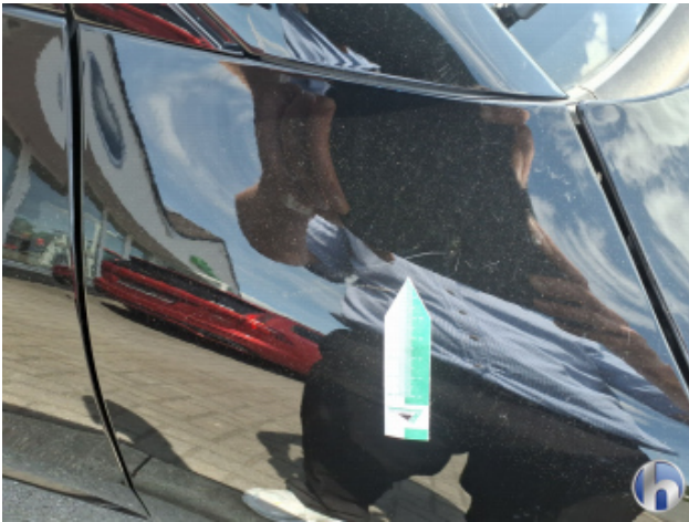
8. Kotflügel Vorne - Rechts Kratzer - Lackieren
