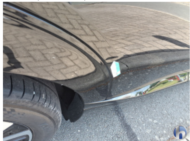
10. Tür Hinten - Rechts Verdellt - Sanft Instandsetzen
