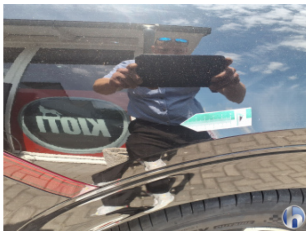
3. Seitenwand - Hinten - Rechts Oberflächenkratzer - Auslegen / Polieren
