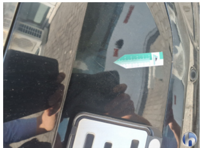
11. Stoßfänger Hinten Kratzer - Lackieren
