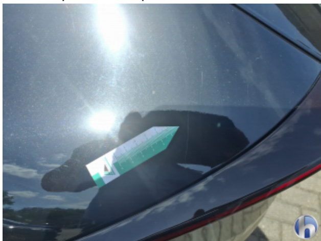
6. Seitenwand - Hinten - Links Kratzer - Lackieren
