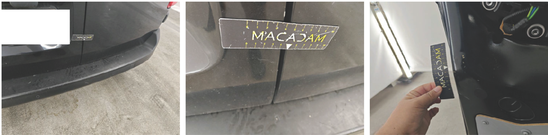
Achterdeur L Deuk(en) en kras(sen) Herstellen en spuiten (compleet) Achterzijde
