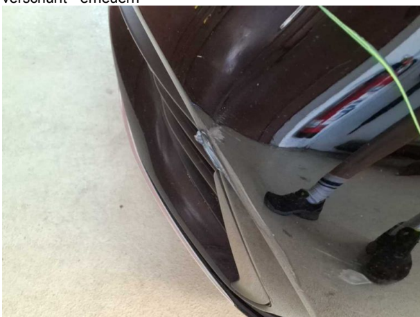
Beschädigung #8: Stossfänger vorn: Stossfänger vorn - verkratzt / verschürft - erneuern
