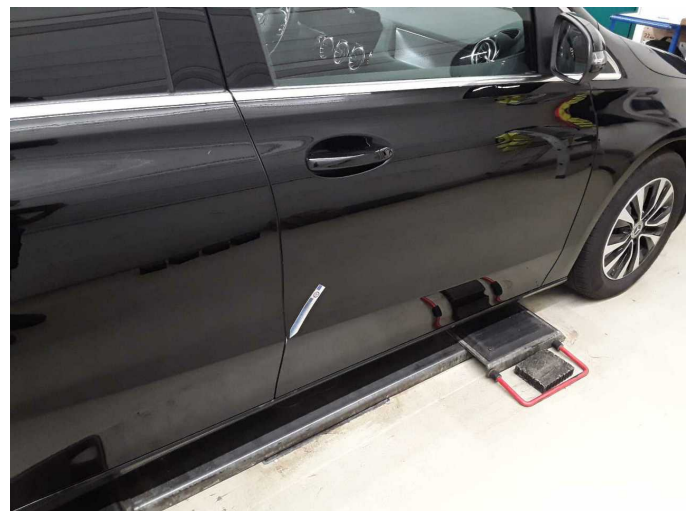
Damage 3: Door - front right side: Door edge (Kante) - Scratch(es) - Smart repair
