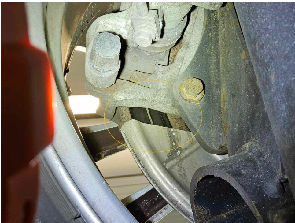
Bild 22 : Bremsscheiben hinten eingelaufen
