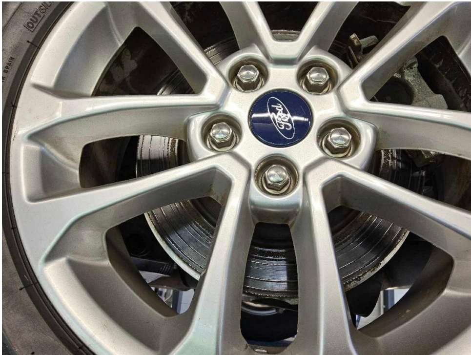
Bild 21 : Bremsscheiben hinten eingelaufen
