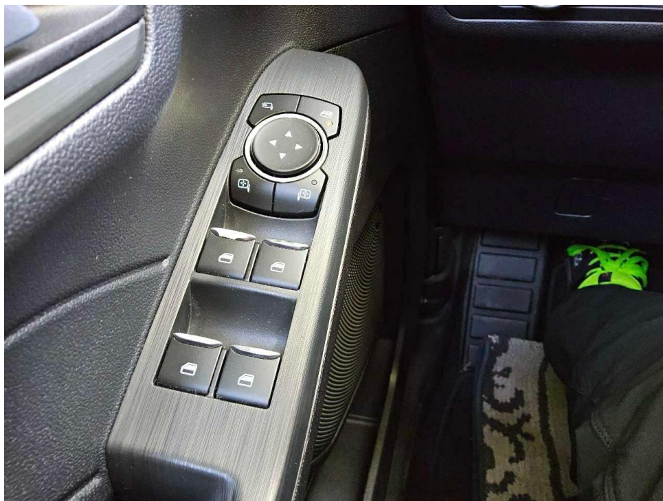
Bild 23 : Fensterheberschalter links Chromablösung
