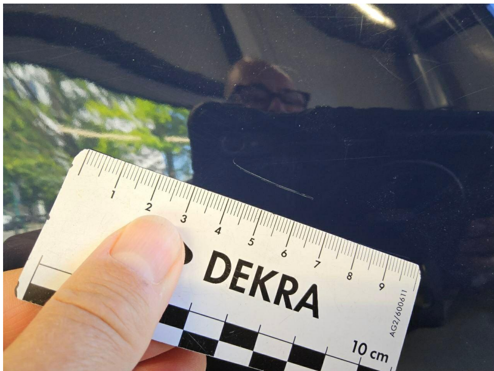
Bild 18 : Stoßfänger hinten zerkratzt, polieren
