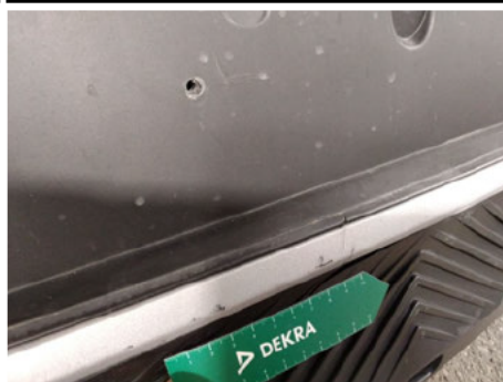
Stoßfängerleiste / Hinten / Gebrochen
