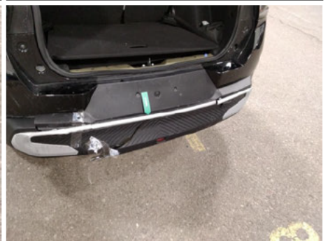
Stoßfängerleiste / Hinten / Gebrochen
