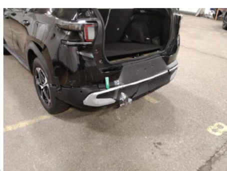
Stoßfängerleiste / Hinten Links / Gebrochen
