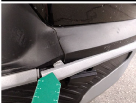
Stoßfängerleiste / Hinten Rechts / Gebrochen
