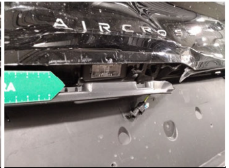
Kennzeichenleuchte / Hinten / Gebrochen
