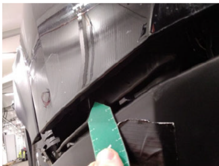
Stoßfänger / Hinten Links / Gebrochen
