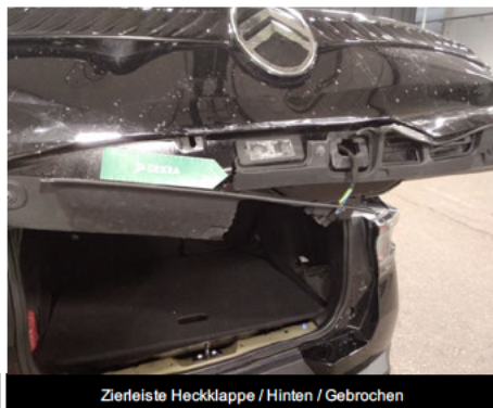
Zierleiste Heckklappe / Hinten / Gebrochen
