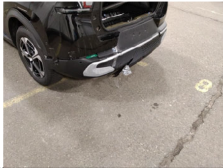
Sensor Einparkhilfe / Hinten Links / Gebrochen
