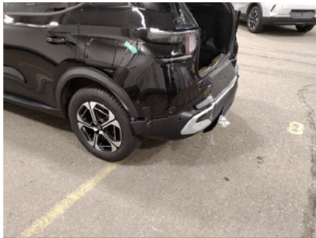
Stoßfänger / Hinten Links / Gebrochen
