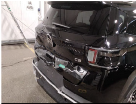
Heckklappe / Kofferraumtür / Hinten / Delle
