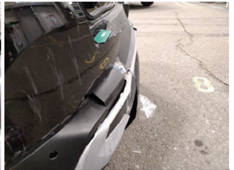
Stoßfänger / Hinten Links / Gebrochen
