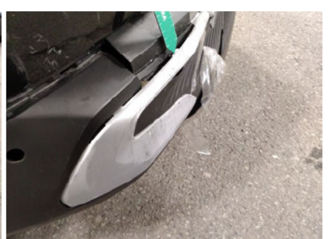
Stoßfängerleiste / Hinten Links / Gebrochen
