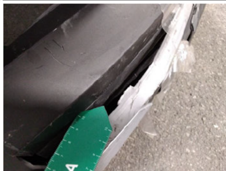
Stoßfängerleiste / Hinten Links / Gebrochen
