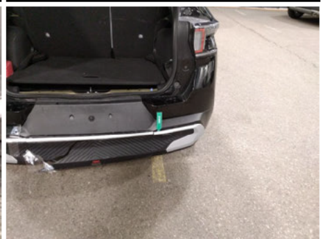
Stoßfängerleiste / Hinten Rechts / Gebrochen
