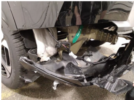
Stoßfängerführung / Hinten Links / Delle
