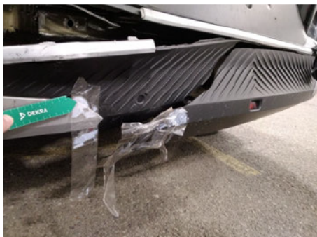
Sensor Einparkhilfe / Hinten / Defekt
