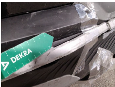
Stoßfängerleiste / Hinten Links / Gebrochen
