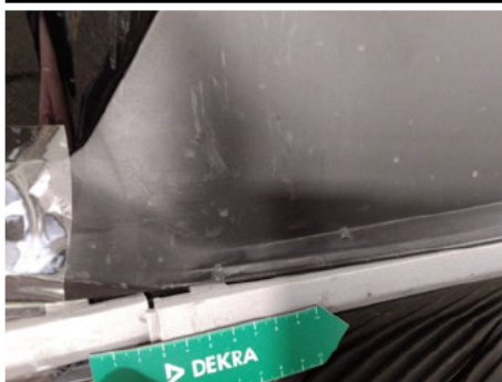
Stoßfängerleiste / Hinten / Gebrochen
