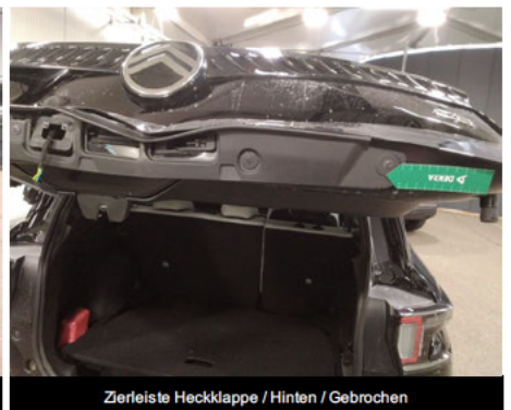
Zierleiste Heckklappe / Hinten / Gebrochen
