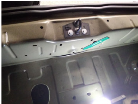
Heckblech / Hinten / Delle
