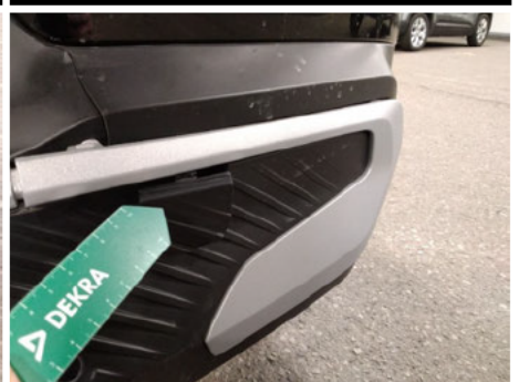
Stoßfängerleiste / Hinten Rechts / Gebrochen
