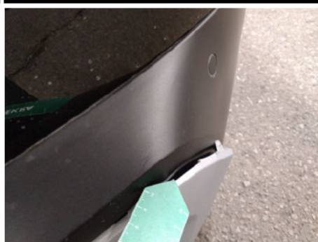
Stoßfängerleiste / Hinten Rechts / Gebrochen
