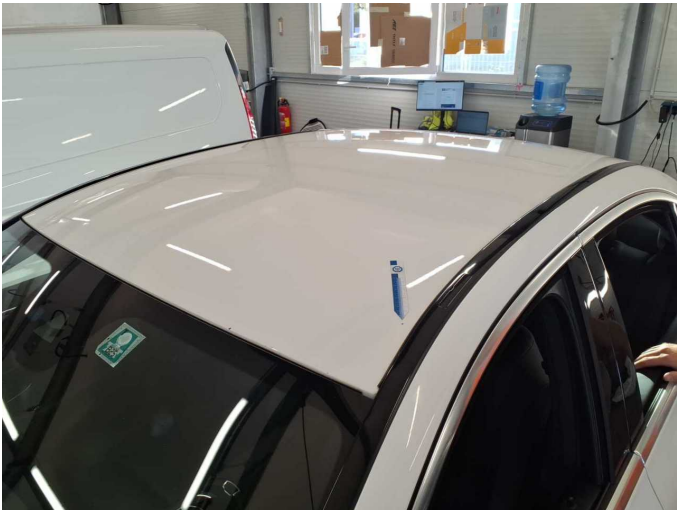
Damage 1: Roof: Roof (Steinschlag mit Korrosion) - Stone chips - Repair and paint
