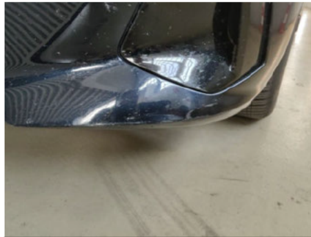
Stoßfänger / Vorne / Delle
