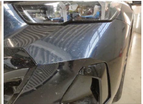
Stoßfänger / Vorne / Delle
