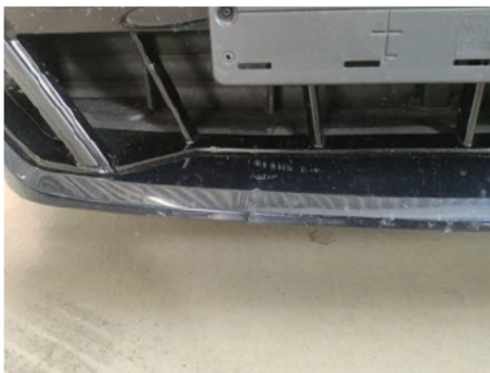
Stoßfänger / Vorne / Delle
