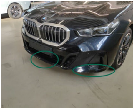
Stoßfänger / Vorne / Delle
