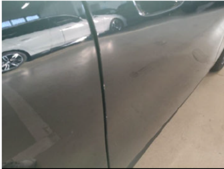
Tür / Hinten Rechts / Kratzer
