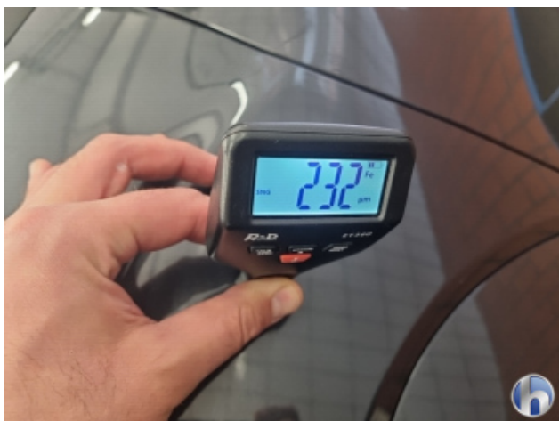
1. Kotflügel Vorne - Links Nachlackiert - Ohne Reparatur
