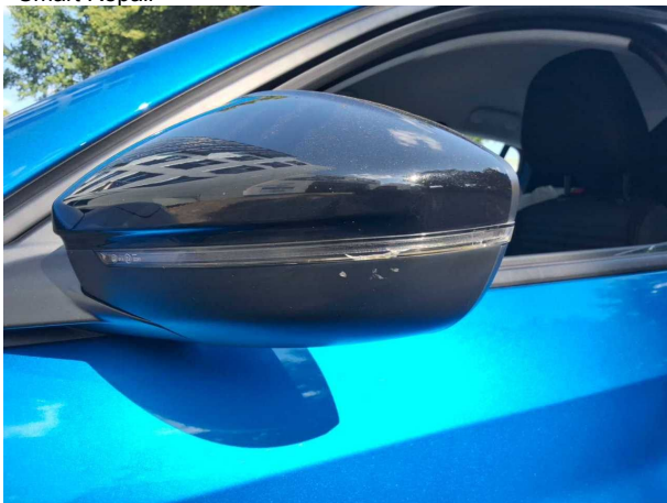
Beschädigung #2: Blinkleuchte: Spiegel links (Spiegelkappe unterhalb Smart Repair) - gebrochen / gerissen - erneuern
