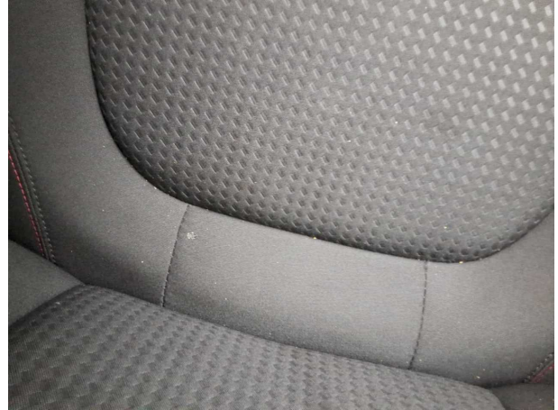
Beschädigung #1: Sitz vorn: Sitzbezug rechts - Brandloch - erneuern
