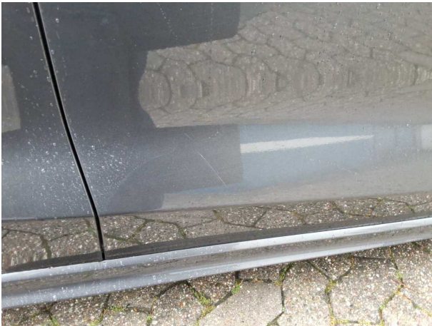
Beschädigung #2: Tür vorn rechts: Tür - Kratzer - lackieren
