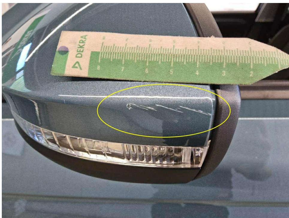
Bild 28 : Außenspiegel links Lackierung, zerkratzt, smart repair
