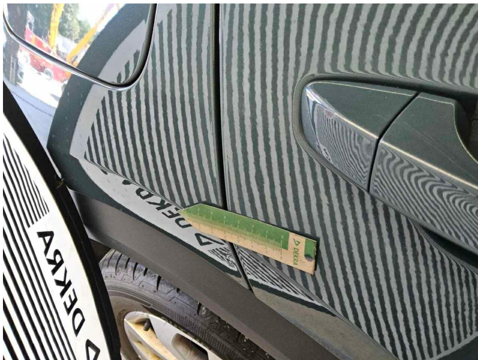
Bild 24 : Tür hinten rechts, eingedellt, Gebrauchsspur
