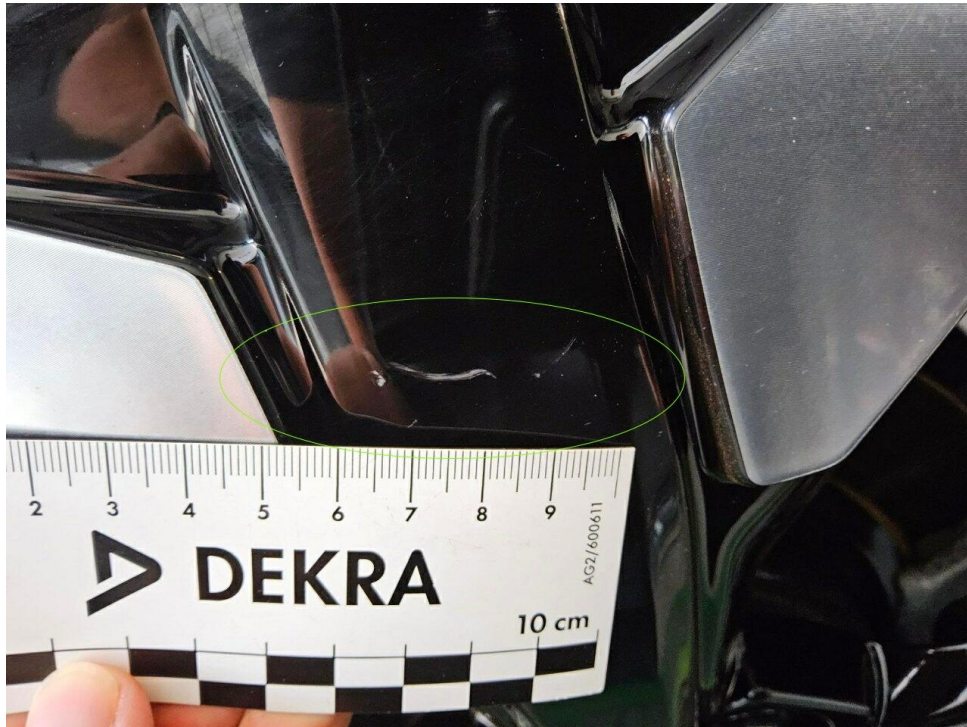
Bild 11 : Felge hinten links, zerkratzt, Gebrauchsspur
