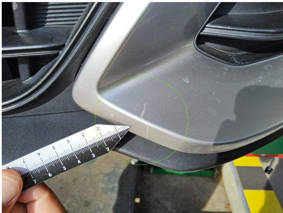
Bild 7 : Stoßfänger vorne Rammschutzleiste links, zerkratzt, Gebrauchsspur
