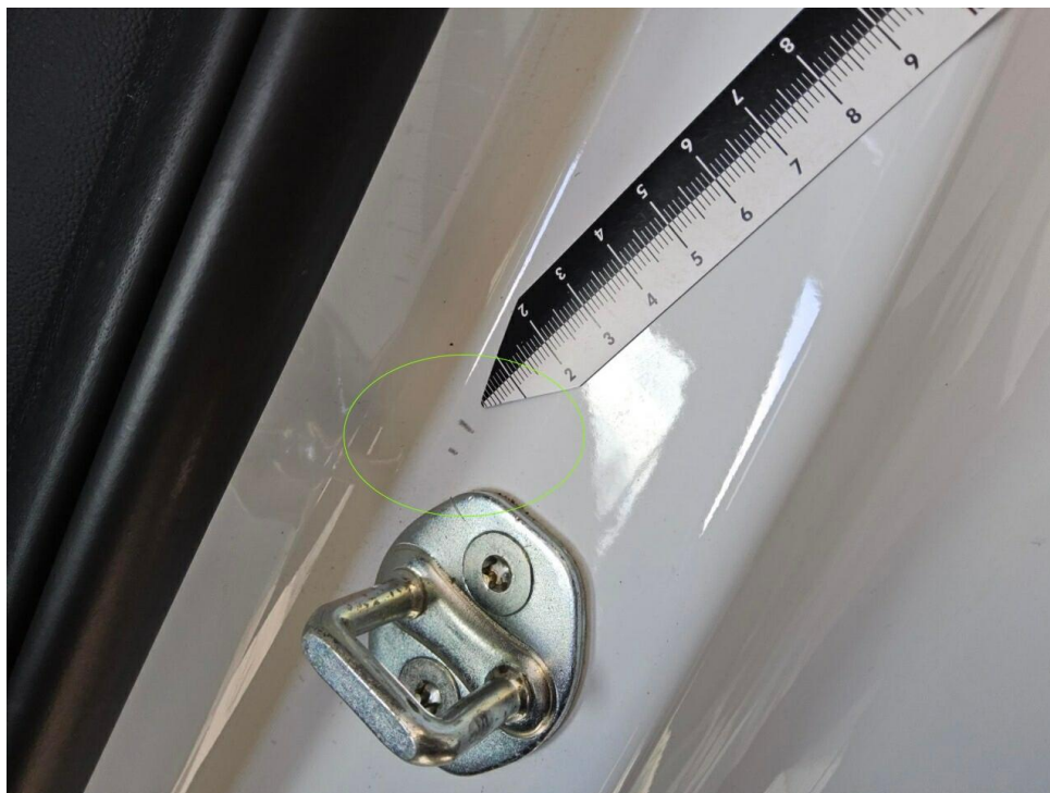
Bild 18 : Tür hinten links Einstieg Lackierung, zerkratzt, smart repair
