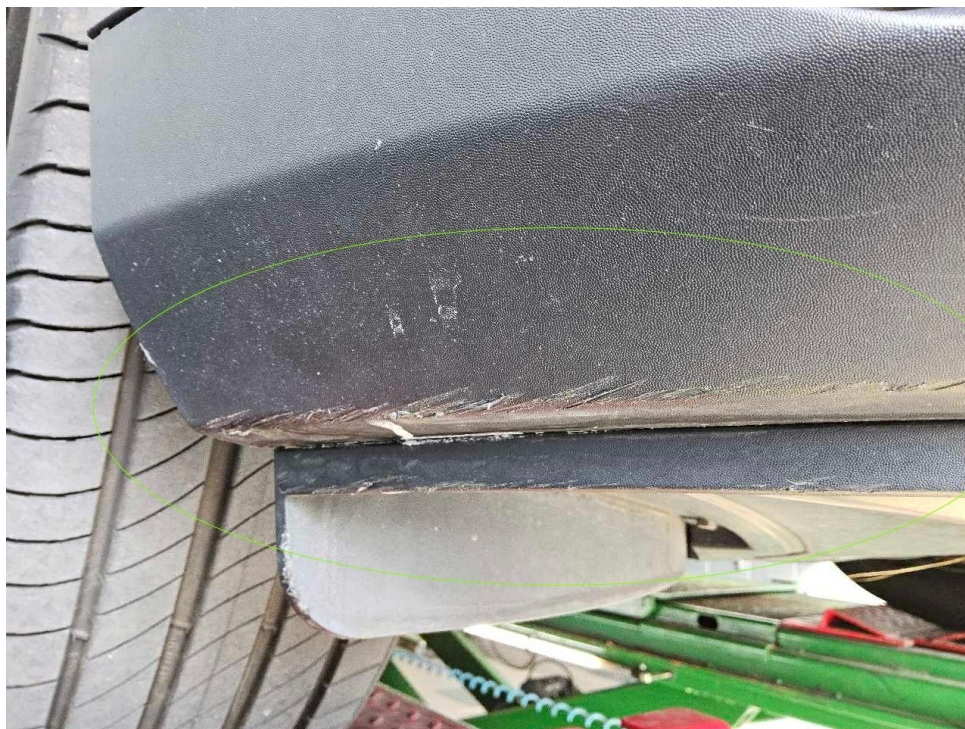
Bild 26 : Frontspoiler Stoßstange Vorne, verschrammt
