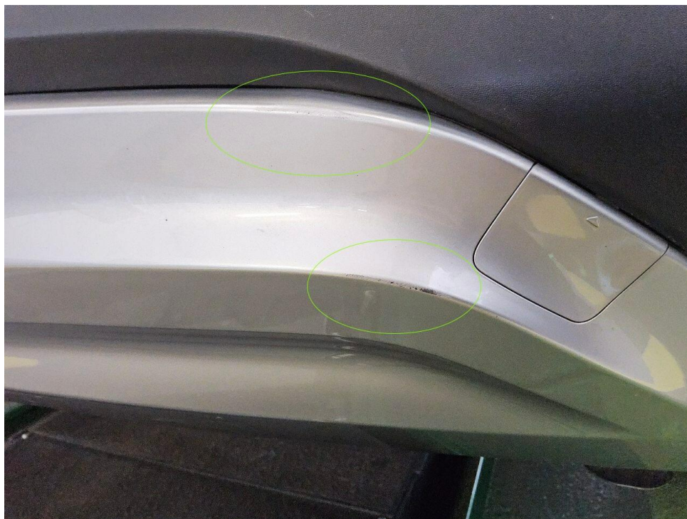
Bild 28 : Spoiler Stoßstange Hinten, verschrammt
