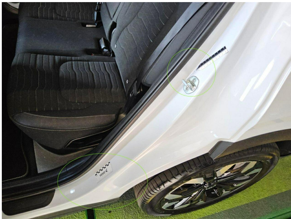
Bild 19 : Tür hinten links Einstieg Lackierung, zerkratzt, smart repair
