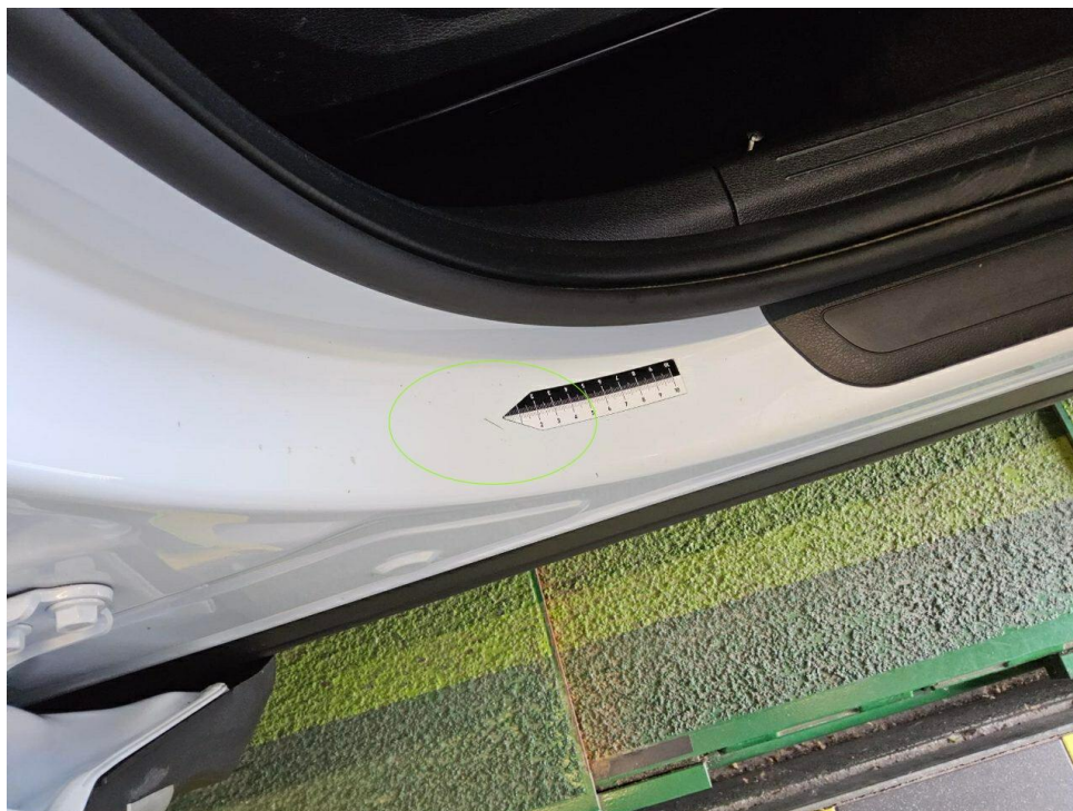
Bild 14 : Tür vorne rechts Einstieg Lackierung, zerkratzt, Gebrauchsspur
