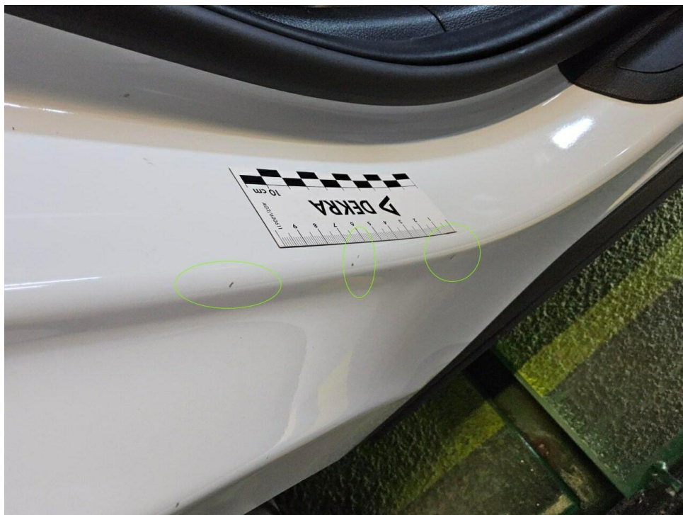
Bild 15 : Tür hinten rechts Einstieg Lackierung, zerkratzt, Gebrauchsspur
