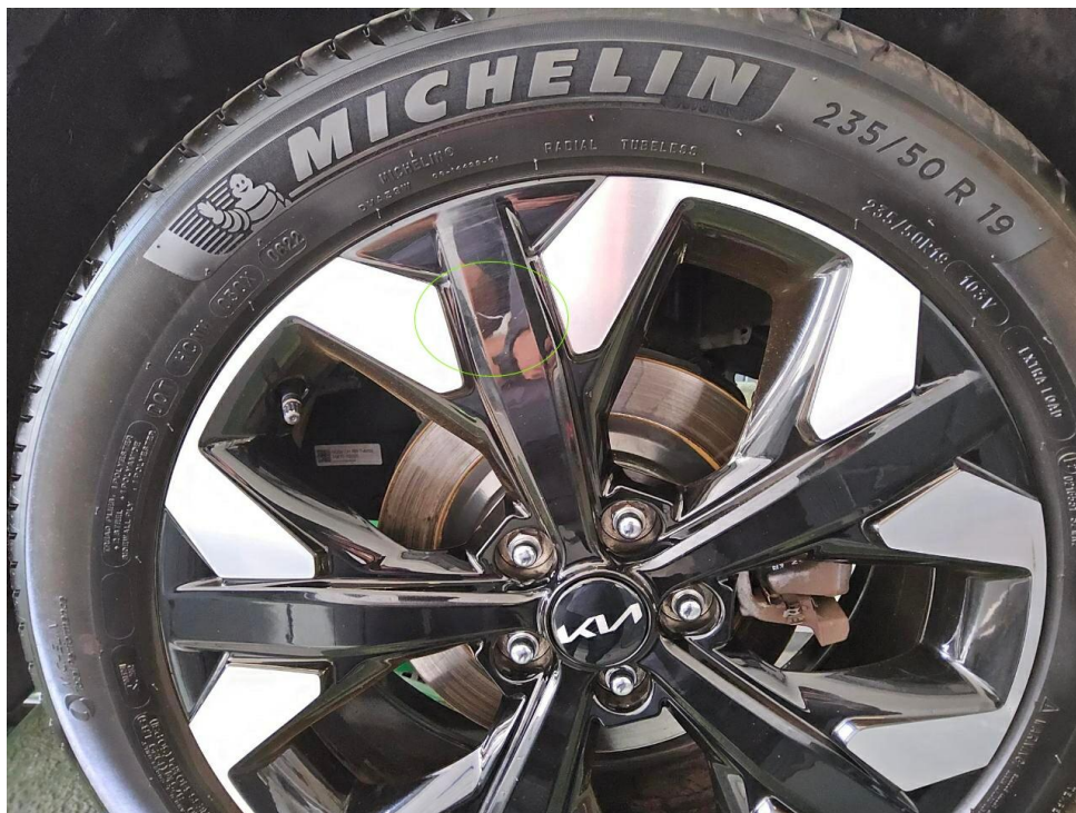
Bild 12 : Felge hinten links, zerkratzt, Gebrauchsspur
