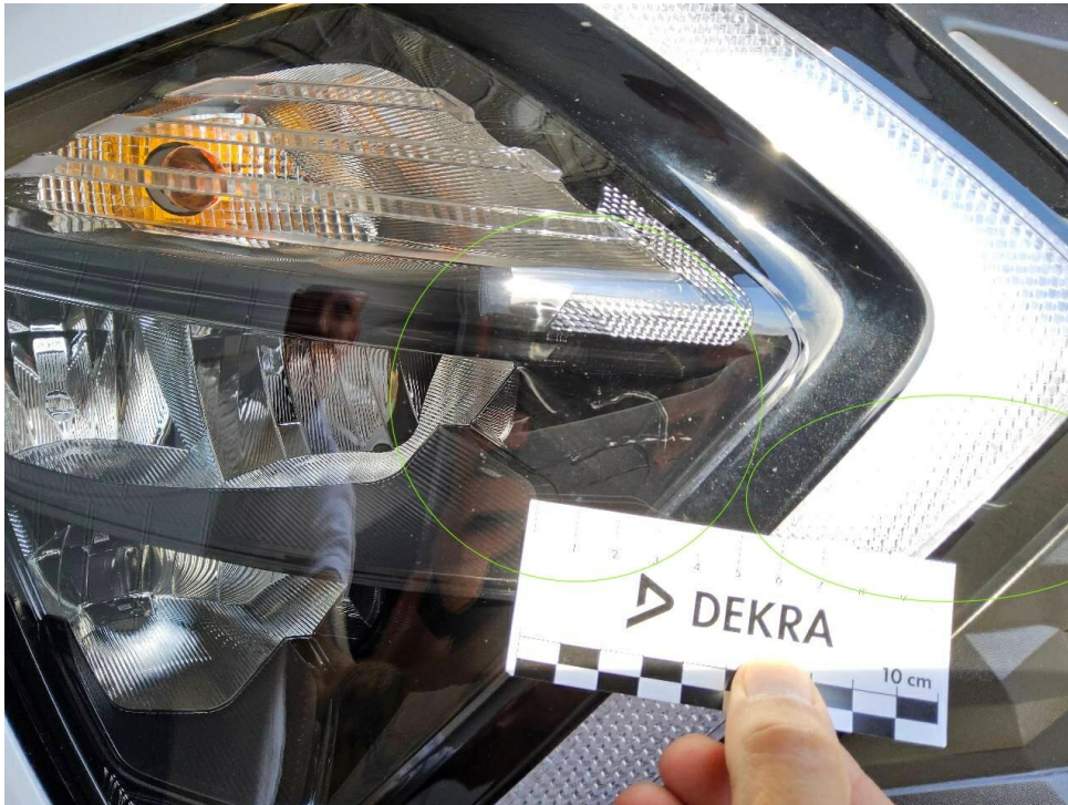
Bild 24 : Scheinwerfer Vorne Rechts, verschrammt
