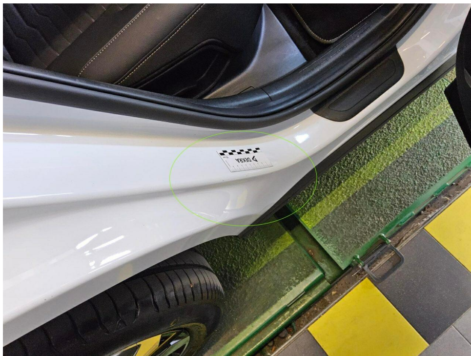
Bild 16 : Tür hinten rechts Einstieg Lackierung, zerkratzt, Gebrauchsspur
