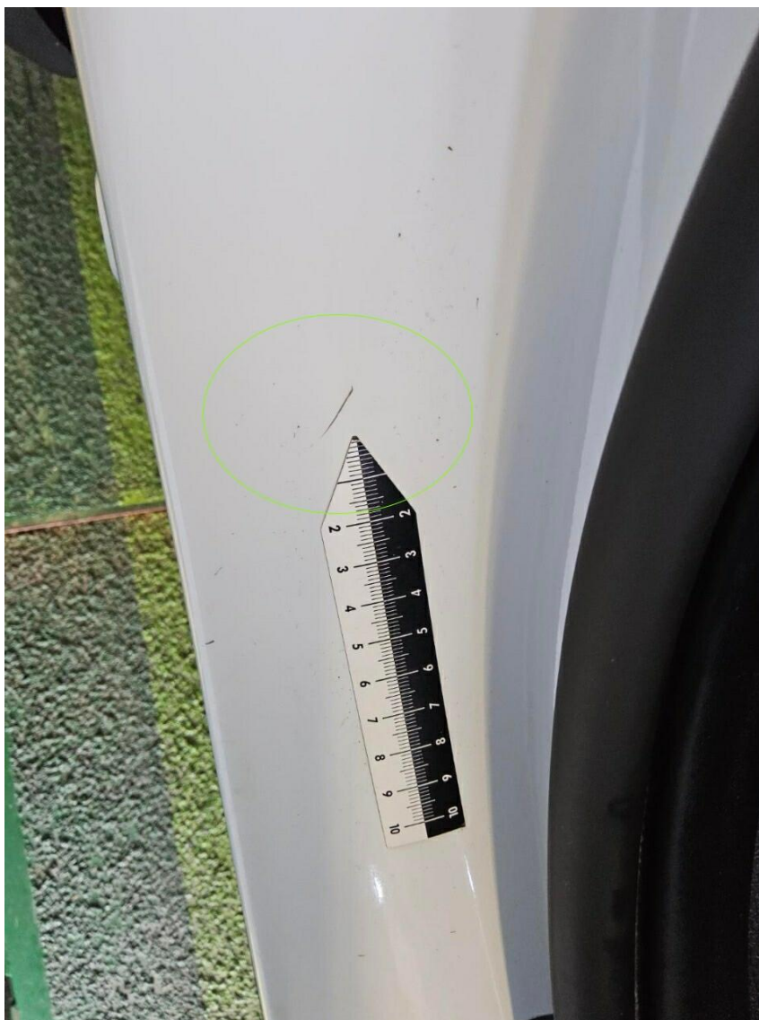
Bild 13 : Tür vorne rechts Einstieg Lackierung, zerkratzt, Gebrauchsspur
