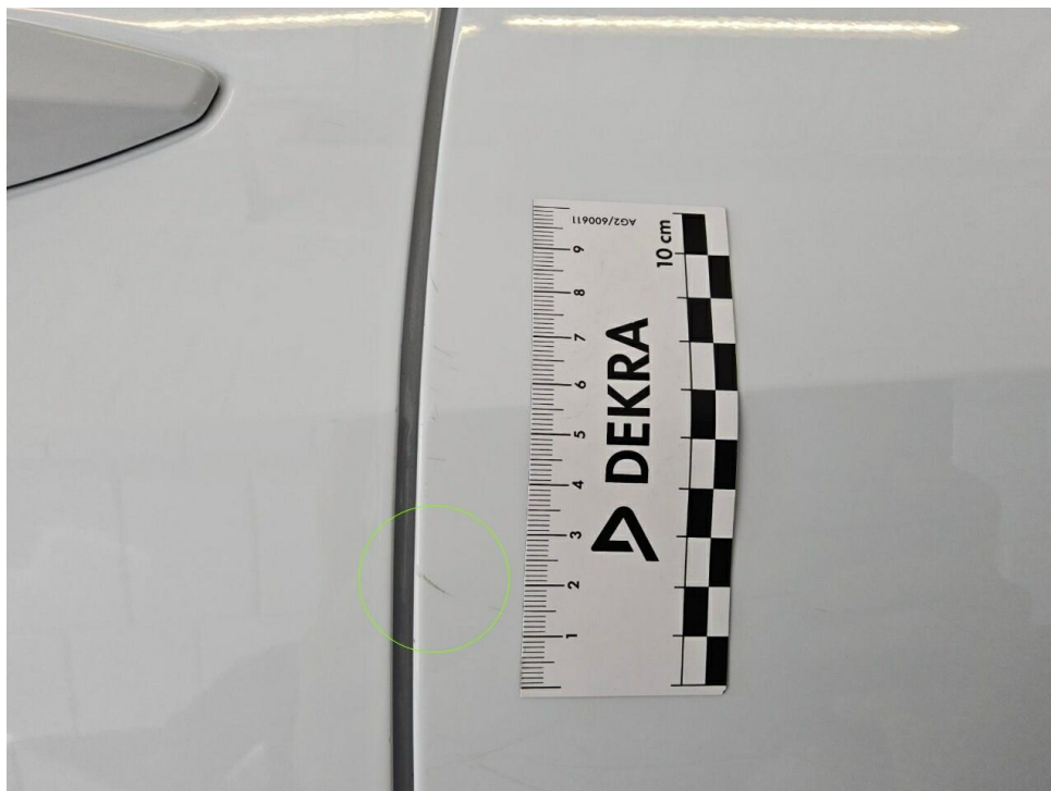
Bild 21 : Tür hinten links Lackierung, zerkratzt, Gebrauchsspur
