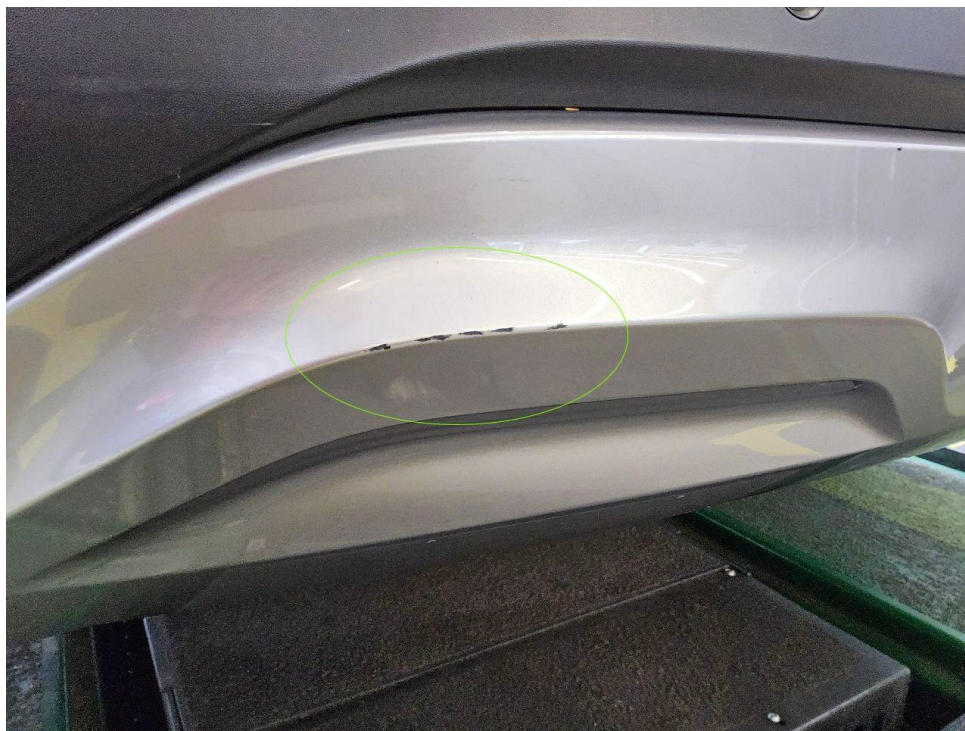
Bild 27 : Spoiler Stoßstange Hinten, verschrammt
