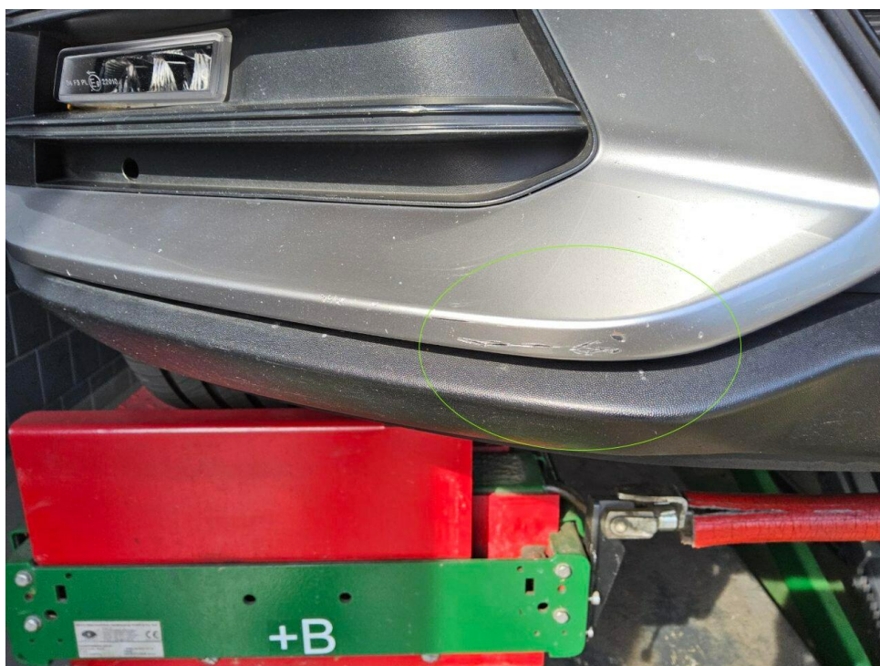
Bild 8 : Stoßfänger vorne Rammschutzleiste rechts, zerkratzt, smart repair
