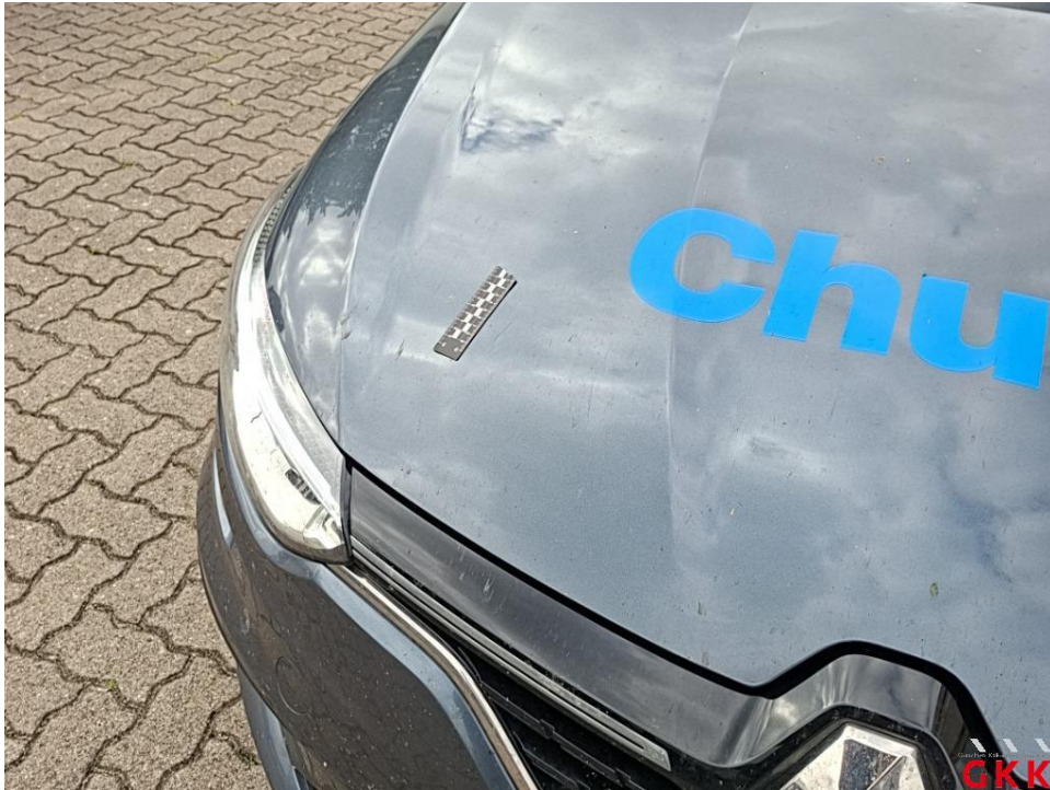
Bild 23. Motorhaube, beschädigt, instand setzen - lackieren
