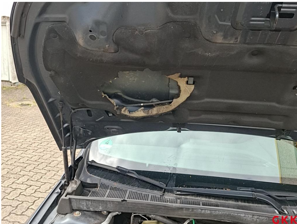
Bild 22. Motorhaube, Dämmmatte, beschädigt, ersetzen
