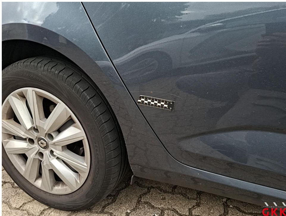
Bild 18. Tür hinten rechts, verkratzt, auslegen, schleifen, polieren
