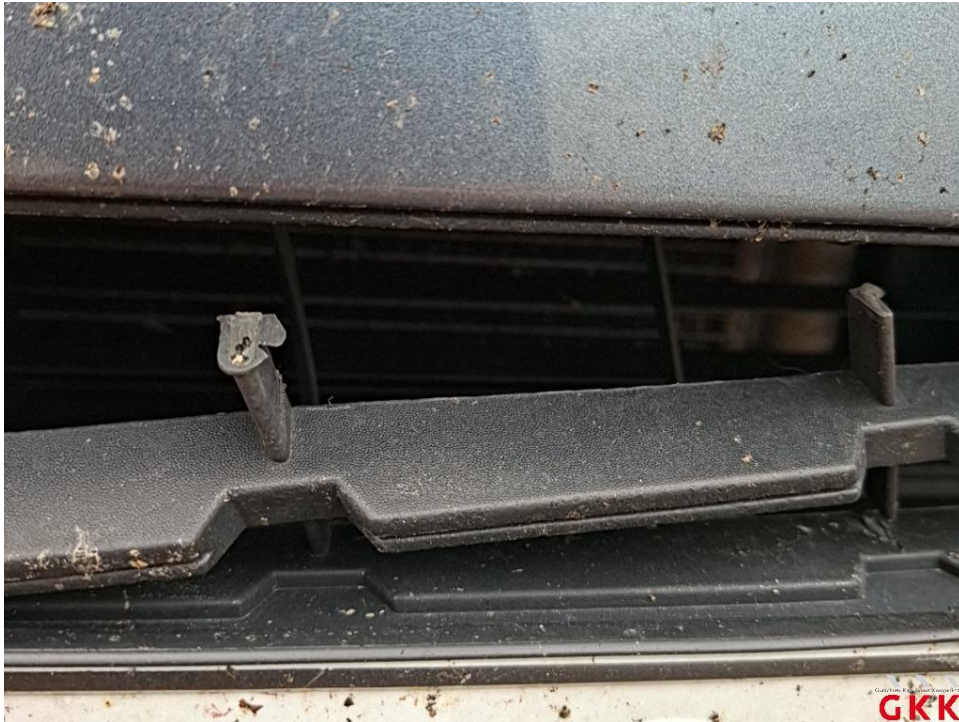
Bild 13. Stoßfänger vorne, Luftgitter, gerissen, ersetzen
