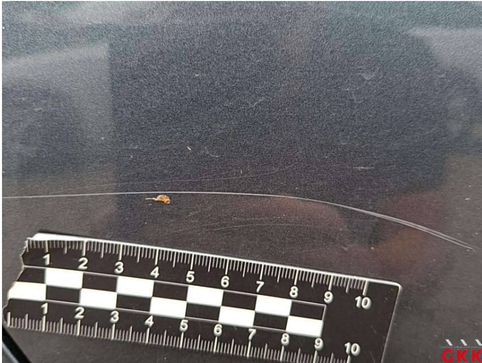
Bild 19. Tür hinten rechts, verkratzt, auslegen, schleifen, polieren
