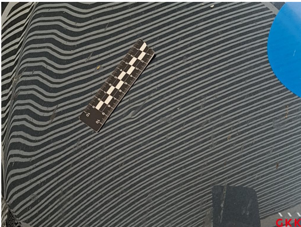
Bild 24. Motorhaube, beschädigt, instand setzen - lackieren
