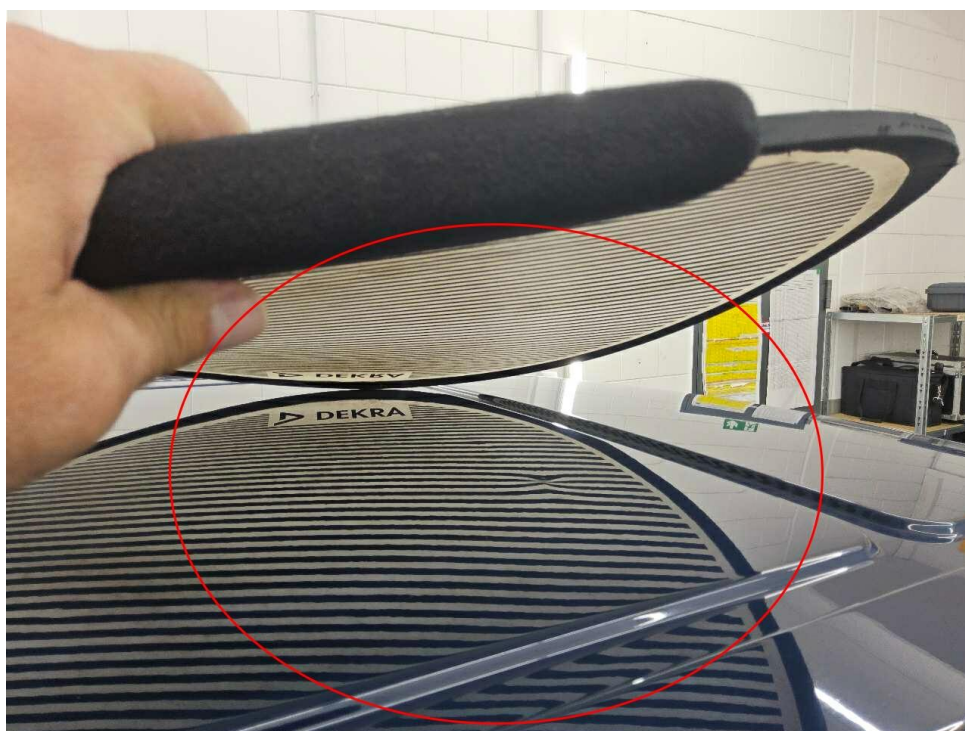
Bild 30 : Dach, mehrfach eingedellt, instandsetzen und lackieren mit Lackaufbau
