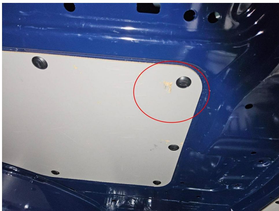
Bild 12 : Innenverkleidung links beschädigt Innenverkleidung rechts beschädigt
