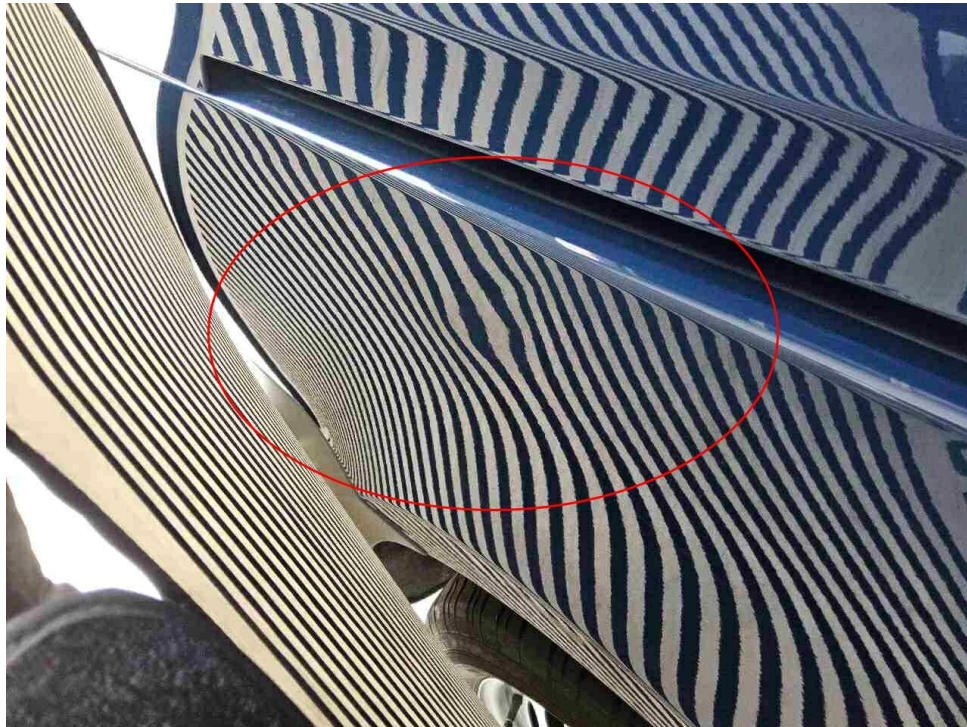
Bild 23 : Seitenwand (lang) hinten rechts, hinten, mehrfach eingedellt, instandsetzen und lackieren mit Lackaufbau
