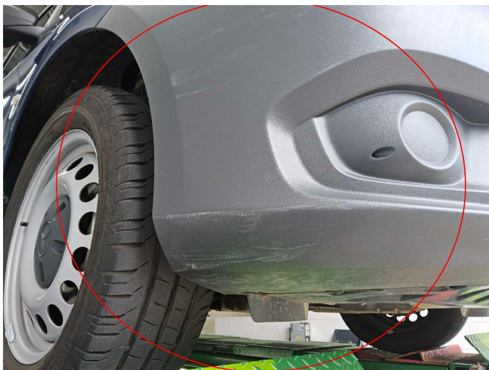
Bild 32 : Stoßstange vorne verschrammt
