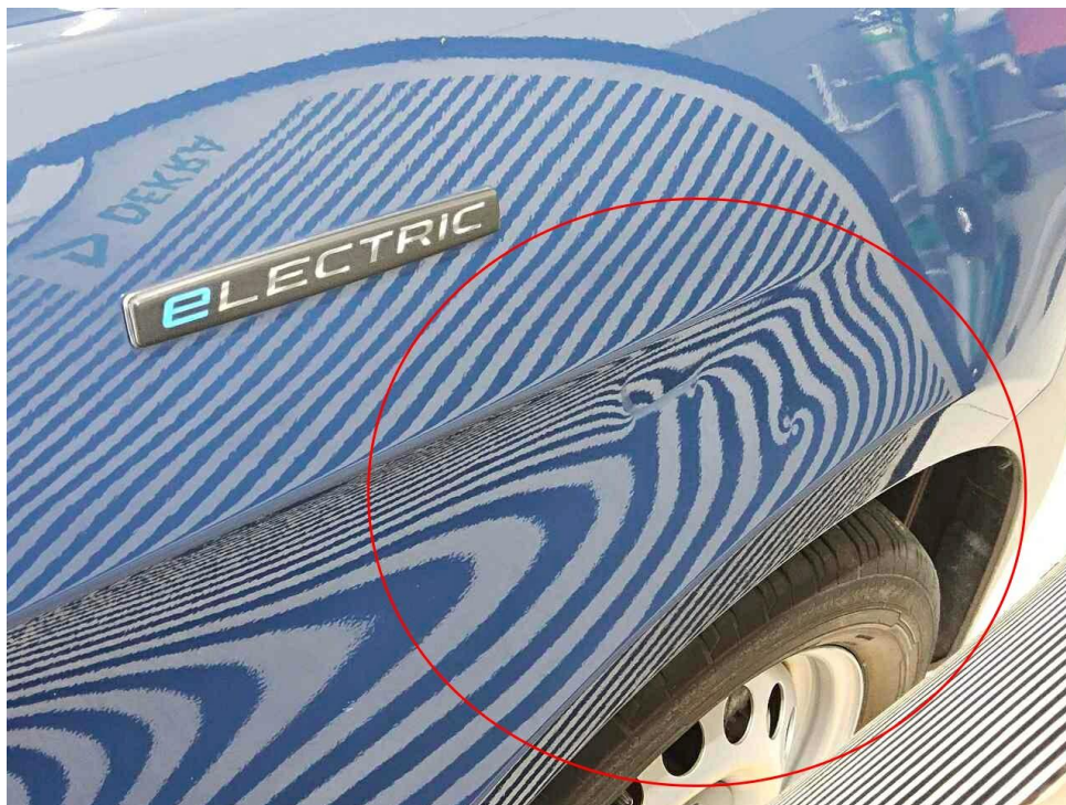
Bild 17 : Kotflügel vorne rechts, mehrfach eingedellt, instandsetzen und lackieren mit Lackaufbau
