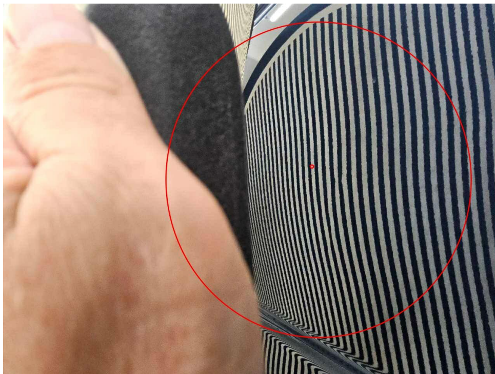
Bild 29 : Seitenwand (lang) hinten links, hinten, mehrfach eingedellt, instandsetzen und lackieren mit Lackaufbau
