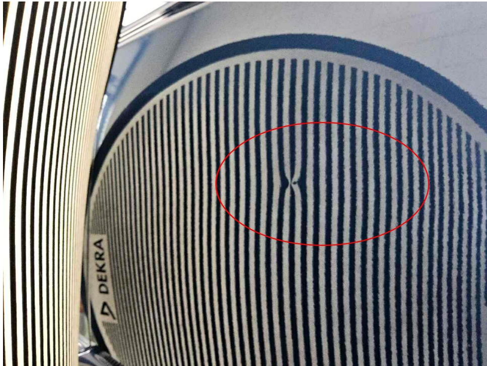
Bild 21 : Schiebetür rechts, mehrfach eingedellt, instandsetzen und lackieren mit Lackaufbau
