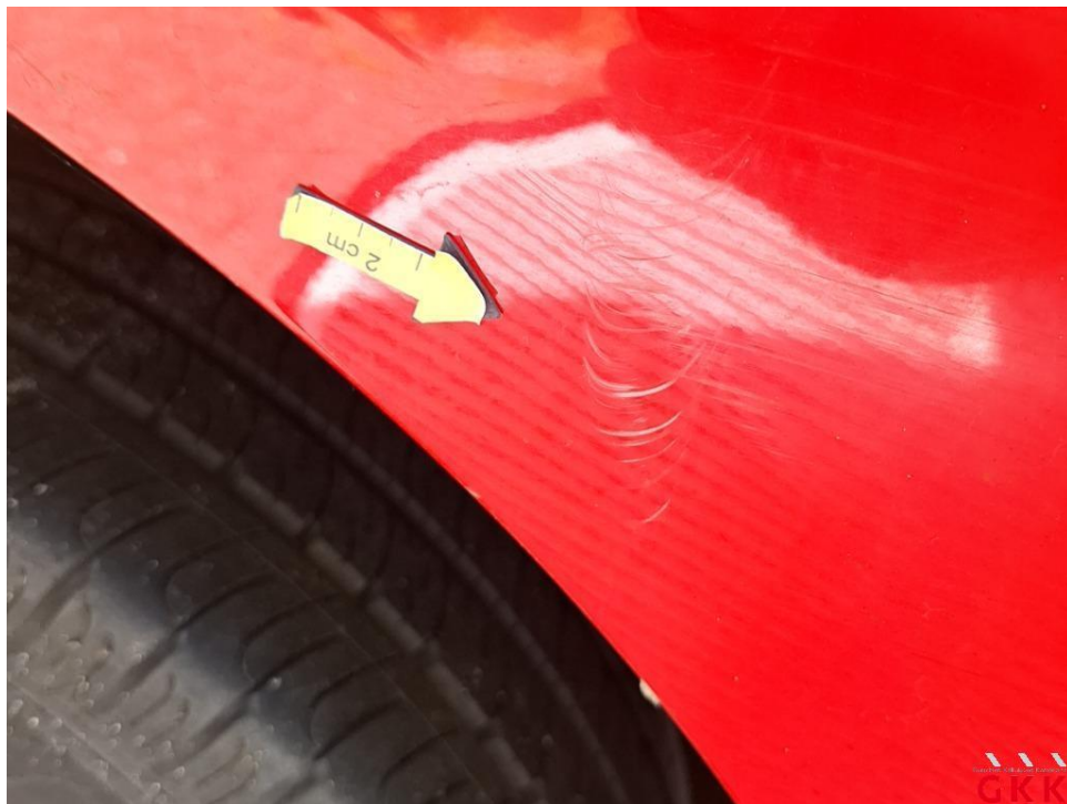
Bild 22. Seitenwand rechts, verkratzt, lackieren
