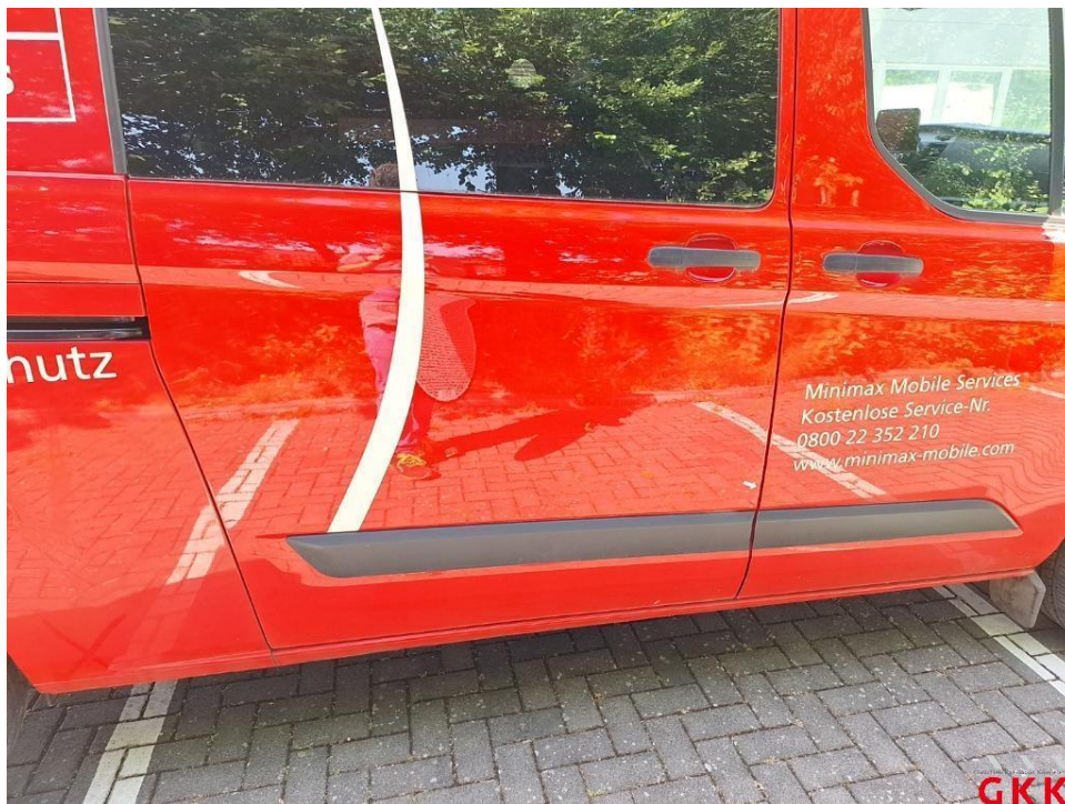
Bild 19. Schiebetür rechts, verkratzt, lackieren
