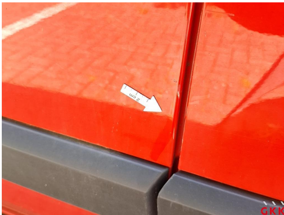
Bild 20. Schiebetür rechts, verkratzt, lackieren
