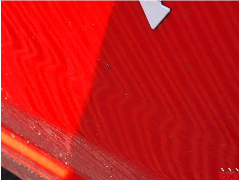
Bild 27. Seitenwand links, beschädigt, instand setzen - lackieren
