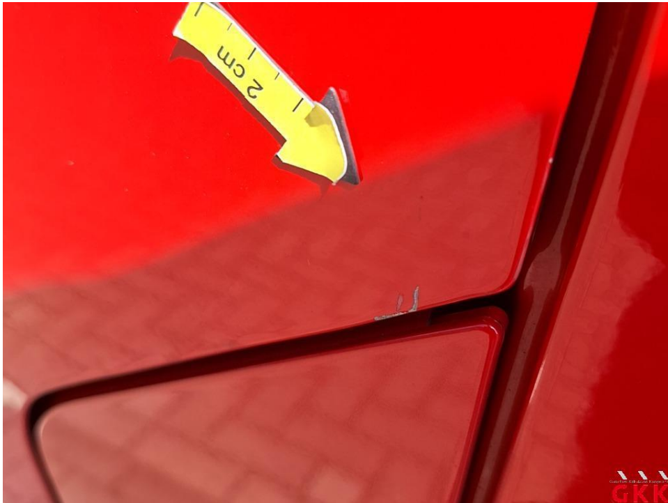
Bild 30. Tür vorne links, beschädigt, instand setzen - lackieren
