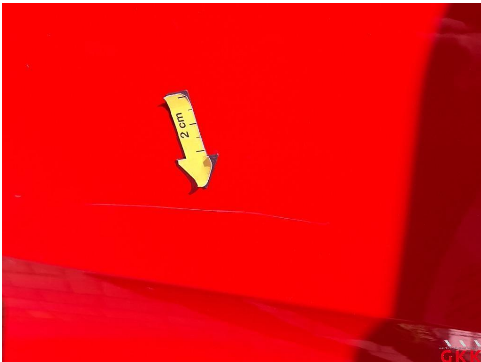
Bild 32. Kotflügel vorne links, verkratzt, lackieren
