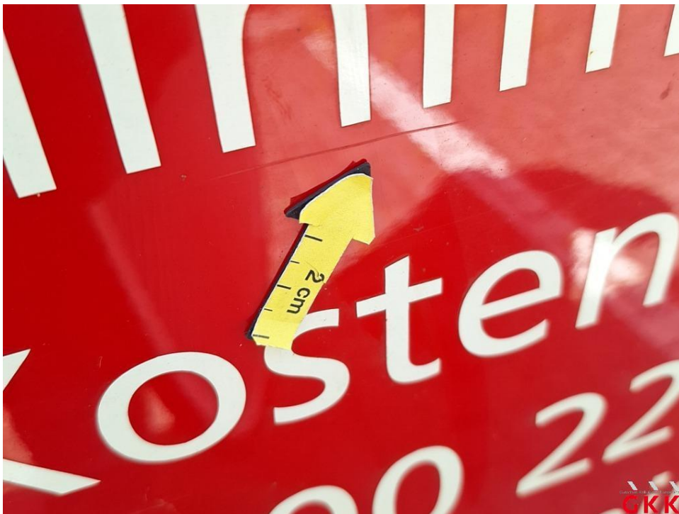
Bild 18. Tür vorne rechts, verkratzt, lackieren
