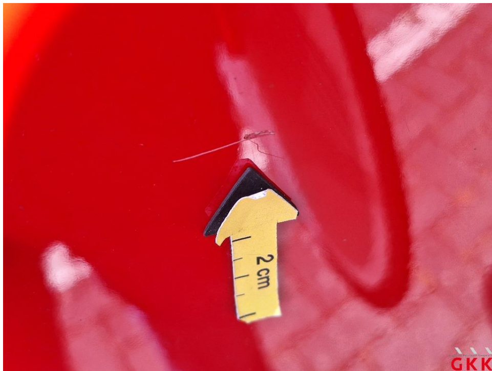
Bild 24. Heckklappe, verkratzt, lackieren
