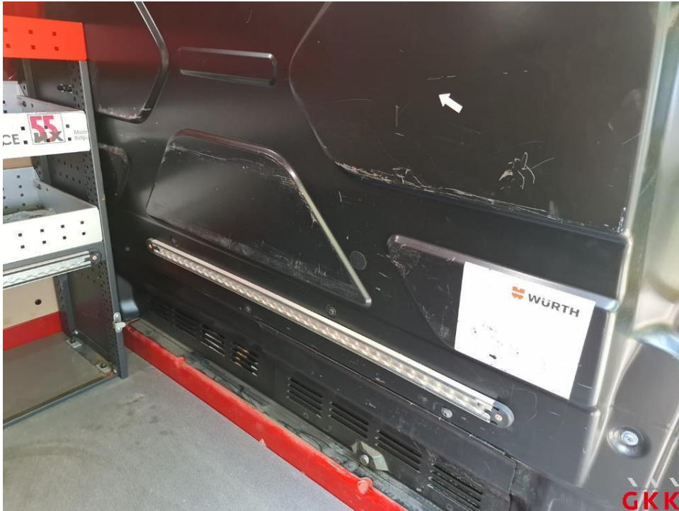
Bild 13. Laderaum, beschädigt, Smartrepair
