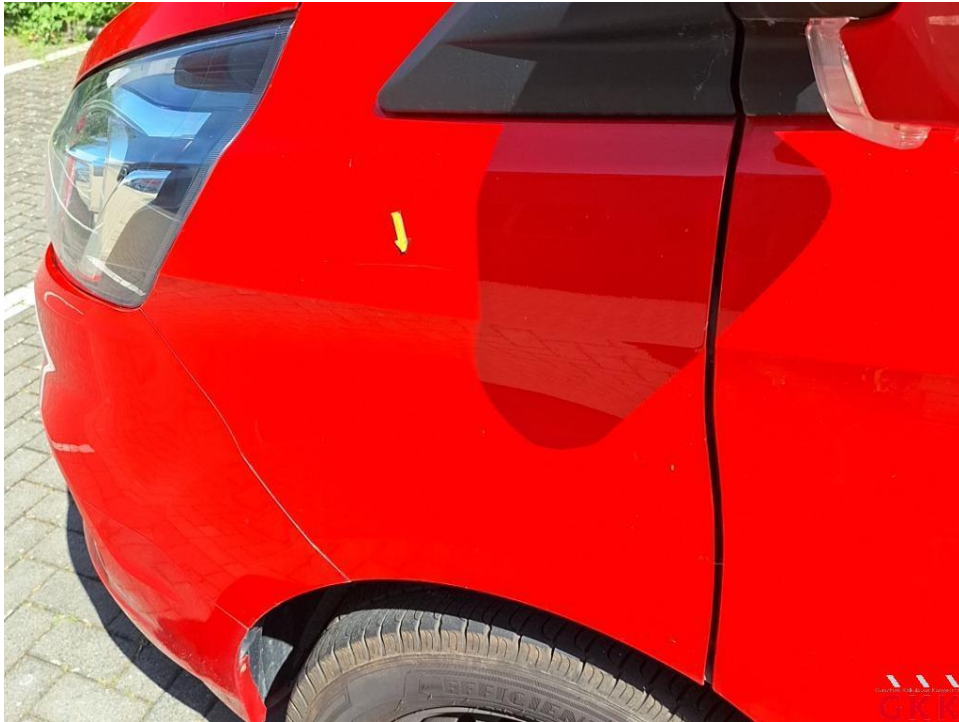
Bild 31. Kotflügel vorne links, verkratzt, lackieren
