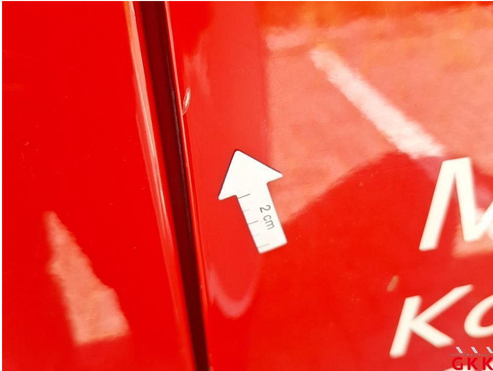
Bild 17. Tür vorne rechts, verkratzt, lackieren
