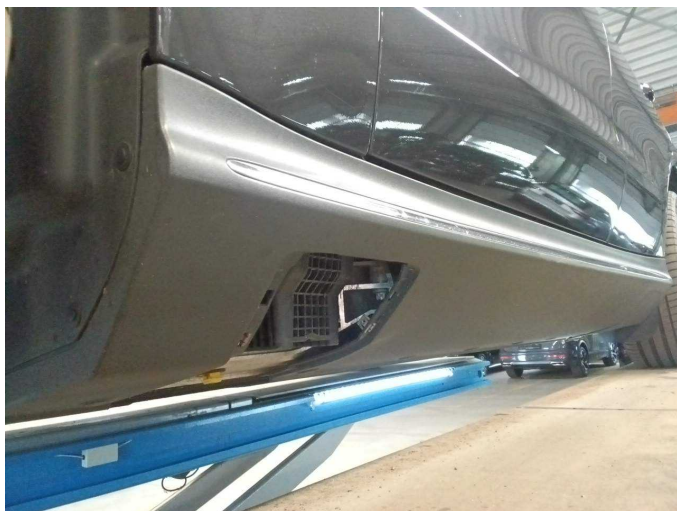
Damage 1: Sill - left side: Trim (Abdeckungs fehlt) - Missing - Perform
